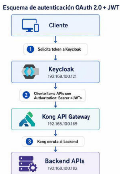
Figura 18. Esquema de autenticación y autorización implementado en la arquitectura segura.
