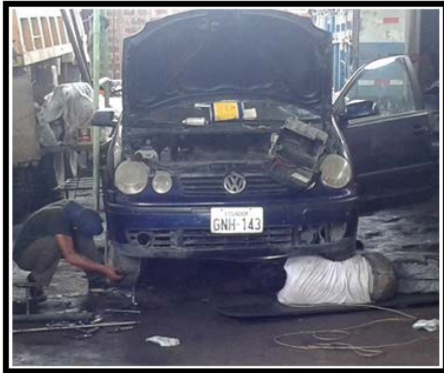
Figura 6. Bahía de lubricación, cambio de filtros de aceite
