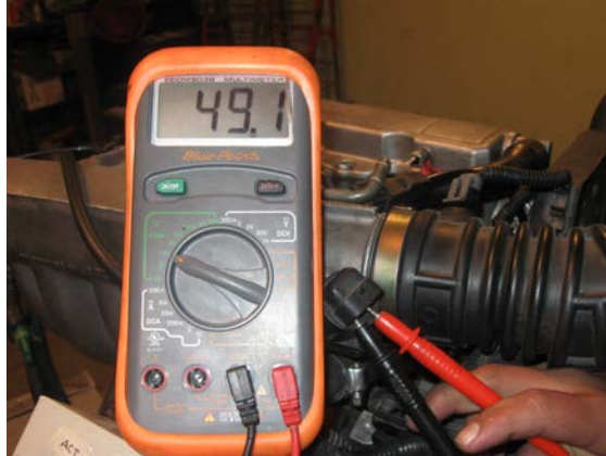
Gráfico No.- 3.45 Verificación de las Resistencias de las Bobinas
