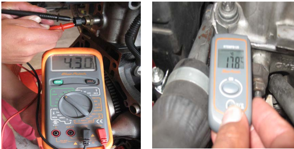
Gráfico No.- 3.20 Verificación de Resistencia Sensor Temperatura
