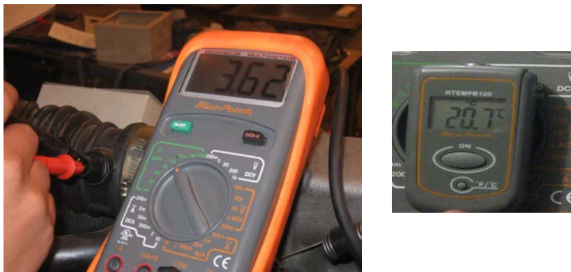
Gráfico No.- 3.36 Verificación de la Resistencia Eléctrica del Sensor
