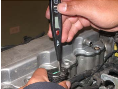
Gráfico No.- 3.39 Verificación de la Tierra del Sensor de Rotación
