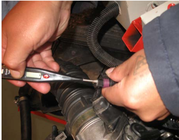
Gráfico No.- 3.27 Verificación de la Tierra (TPS)
