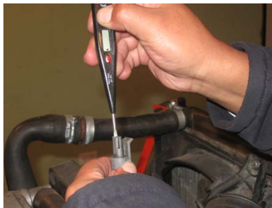
Gráfico No.- 3.33 Verificación de la tierra del Sensor de Temperatura
