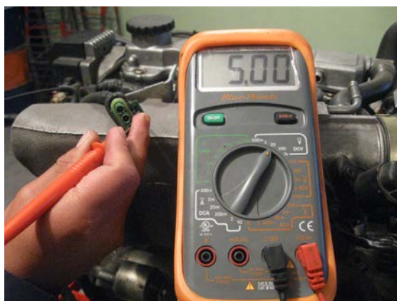
Gráfico No.- 3.30 Verificación del Voltaje de Entrada Sensor MAP
