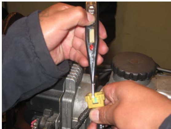
Gráfico No.- 3.42 Verificación de la Alimentación Positiva
