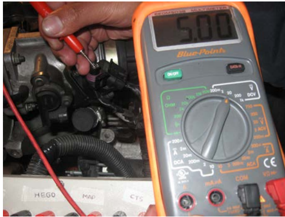
Gráfico No.- 3.26 Verificación del Voltaje de Entrada (TPS)
