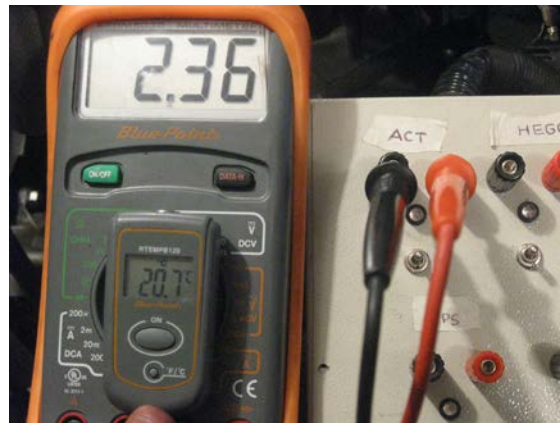
Gráfico No.- 3.34 Verificación del Voltaje de Retorno Sensor de Temperatura
