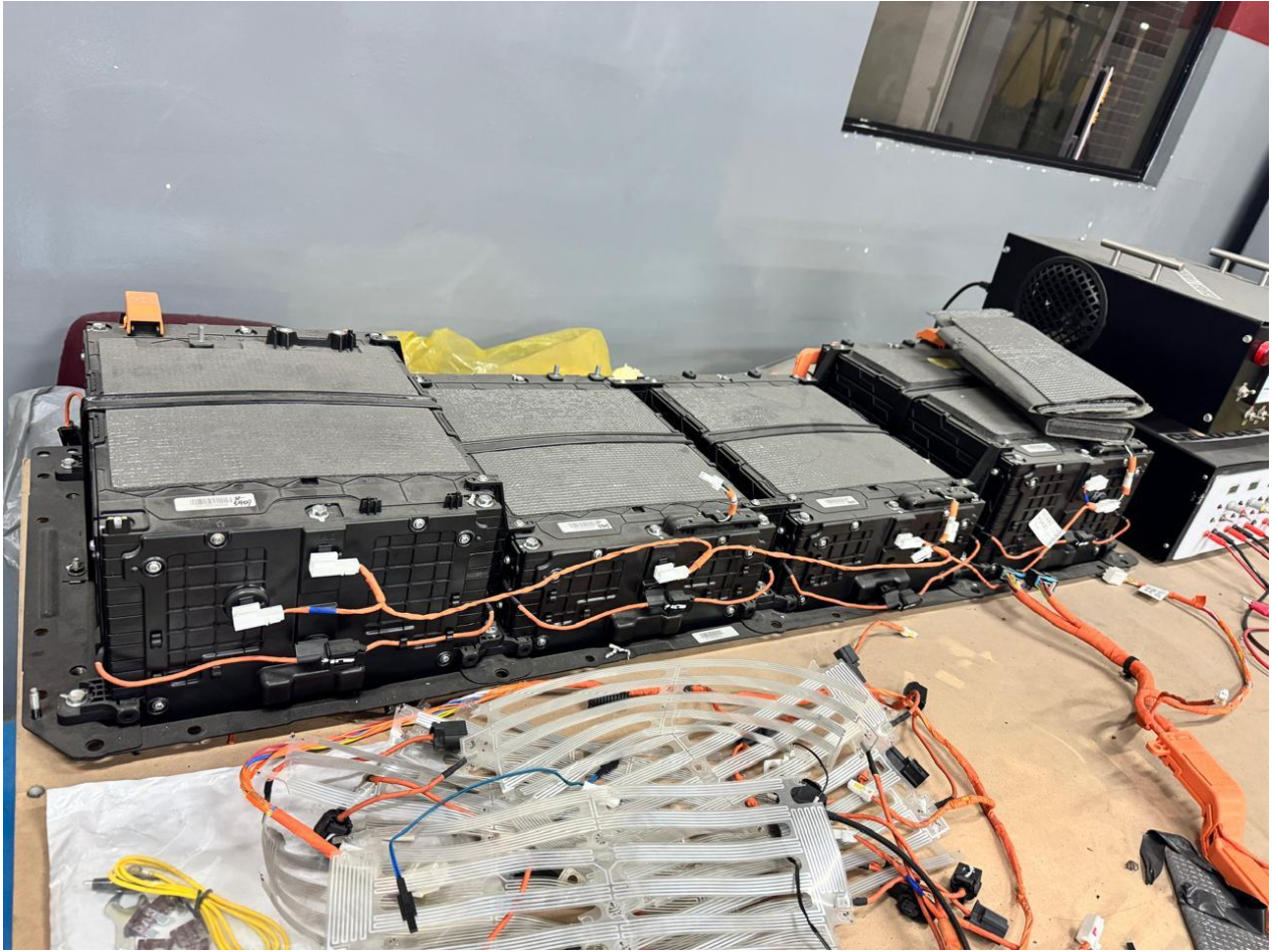
Anexo 50. Modulo completo de baterías.
