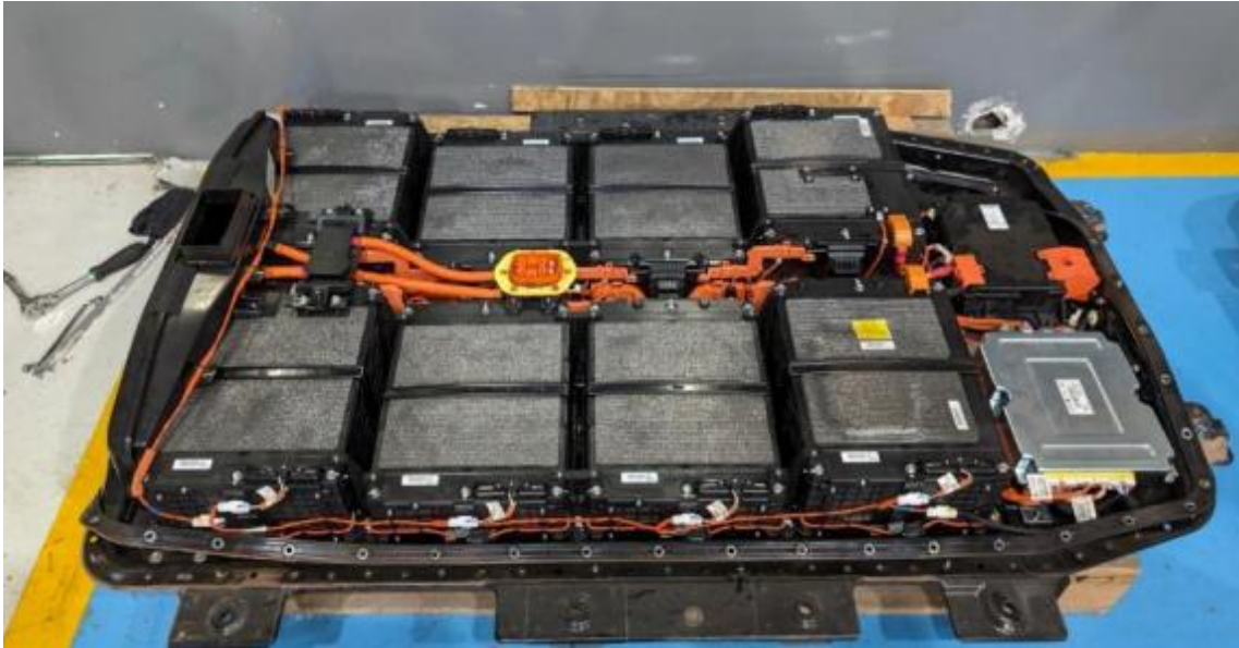
Anexo 52. Batería completa de vehículo eléctrico.
