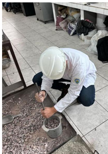
Fig. 9. Ejecución de ensayo de densidad aparente en agregados
