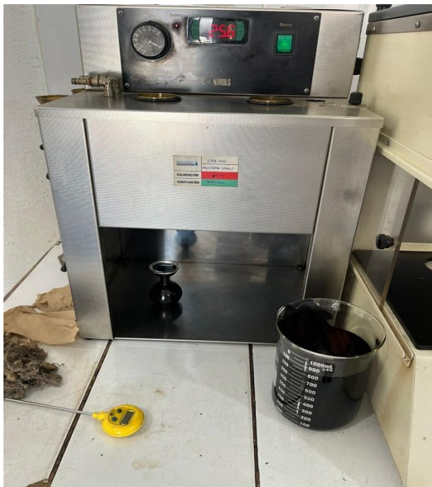
Fig. 11. Equipo de viscosímetro Saybolt Furol utilizado para la caracterización técnica de ligantes asfálticos
