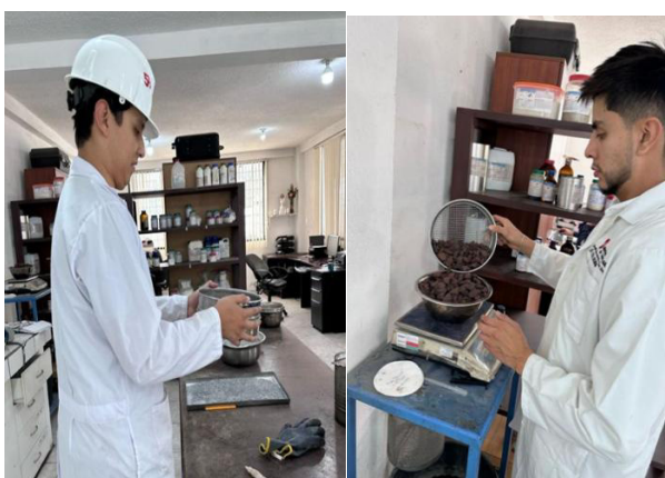
Fig. 7. Colocación del respectivo material en las fajas de tamices y se pesa el material previo a realizar la granulometría por lavado
