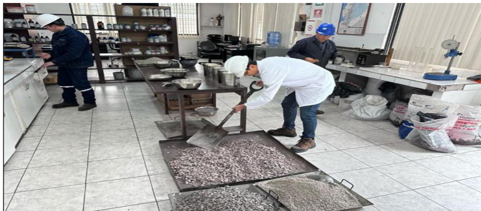
Fig. 5. Colocación de material ( 3/4 , 1/2 y polvo de piedra) de la cantera de Holcim
