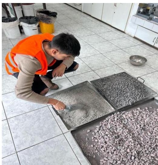
Fig. 6. Homogenización de materiales, previo al ensayo granulométrico
