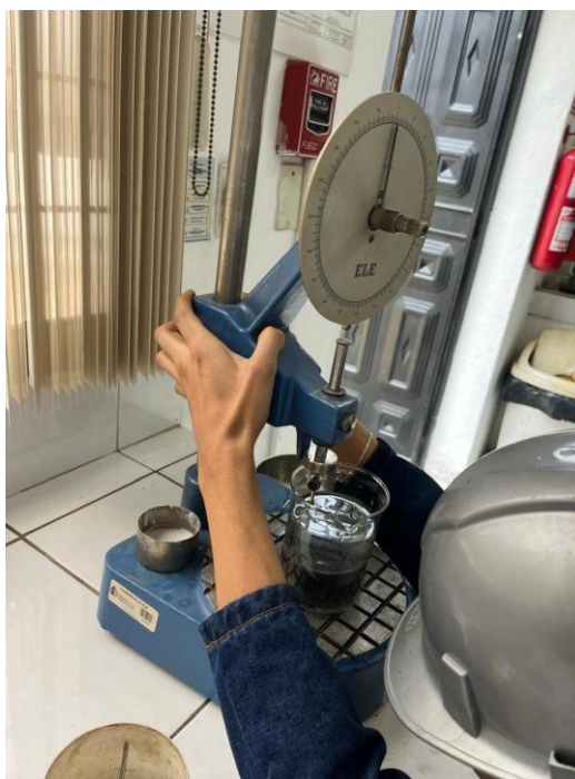
Fig. 15. Ensayo de penetración
