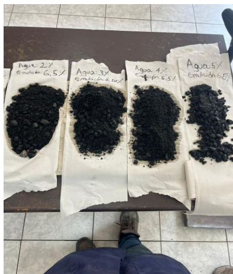
Fig. 17. Definición del porcentaje óptimo de humedad mezcla CSS-1hP
