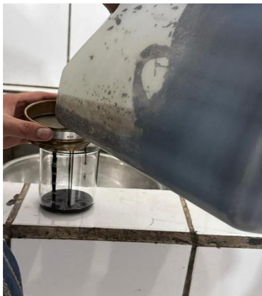
Fig. 12. Preparación de muestra para la ejecución del ensayo de Viscosidad
