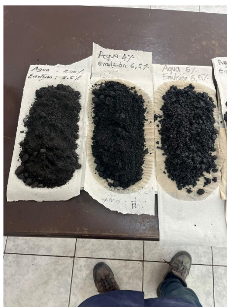
Fig. 17. Definición del porcentaje óptimo de humedad mezcla CSS-1hP
