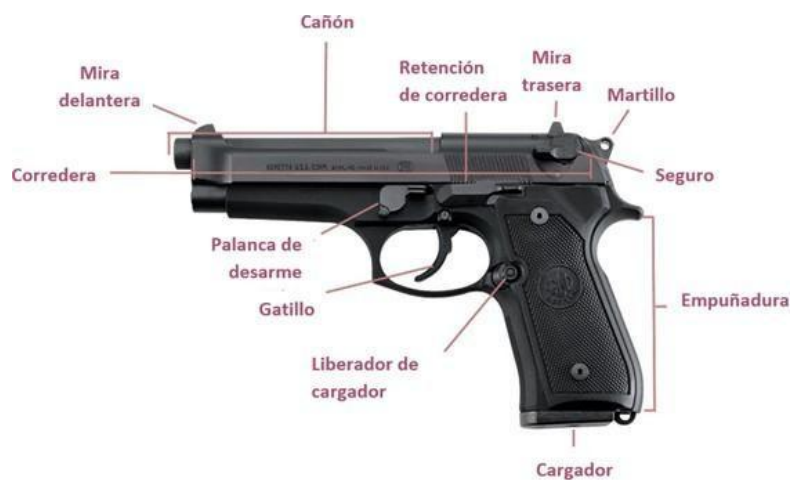
Ilustración 12 Anatomía de un arma corta
