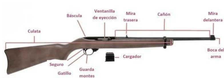
Ilustración 13 Anatomía de la escopeta arma larga
