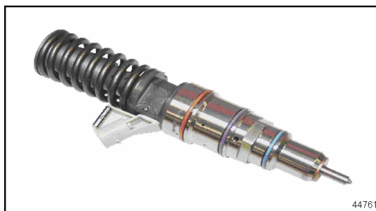
Figura. 1.3 Inyector EUI N3. 3
