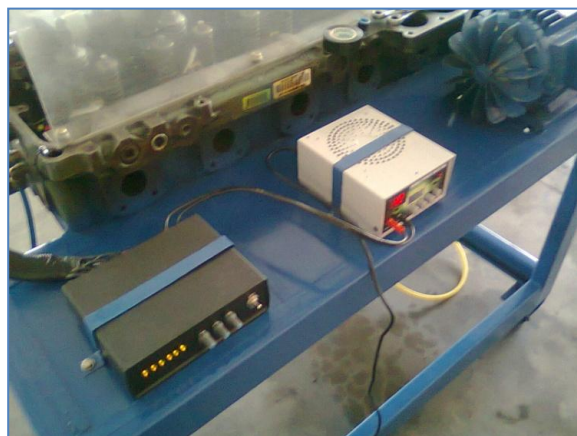
Figura. 2.52 Circuito de Inyectores y Fuente de Voltaje Instalados en el Banco de Inyección.
