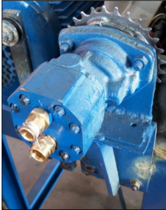
Figura. 2.18 Bomba de Combustible y Bases de Soporte.
