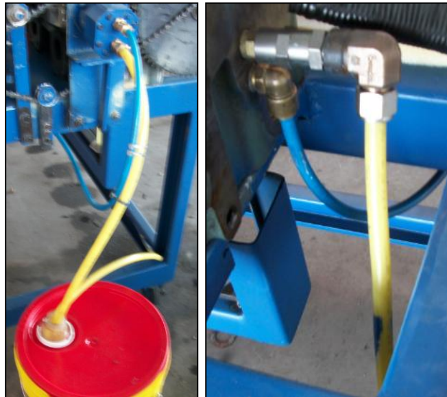
Figura. 2.21 Mangueras de Combustible.
