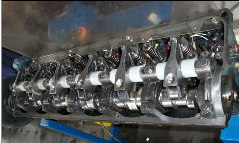
Figura. 2.2 Conjunto del Cabezote.
