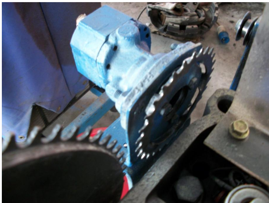
Montaje de la Bomba de Combustible
