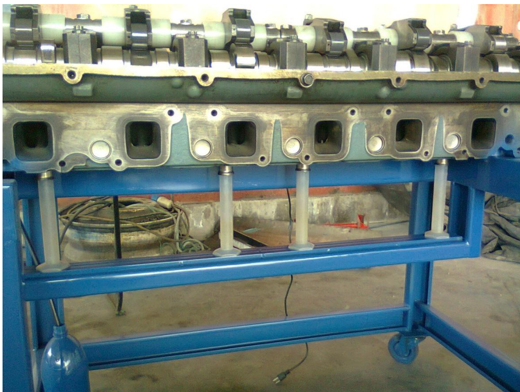
Colocación de las Probetas Plásticas por debajo de las Puntas de Inyector
