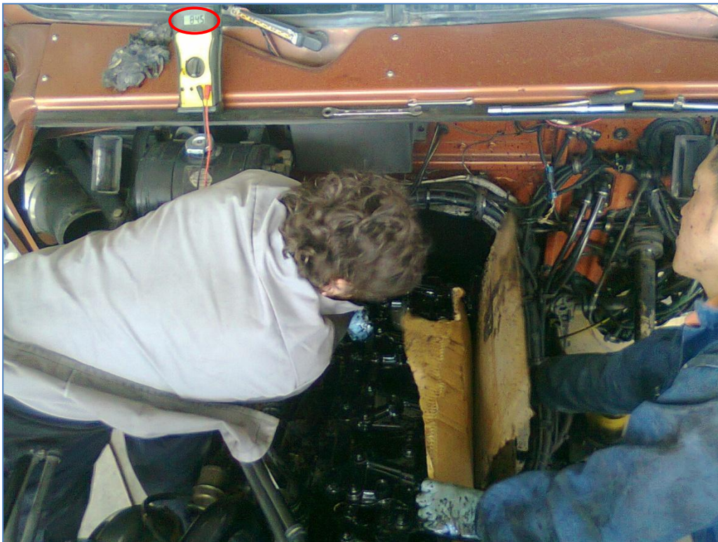
Figura. 2.38 Medición del Pulso de Inyección en un Motor DDS60 a 1400rpm en el Cigüeñal.
