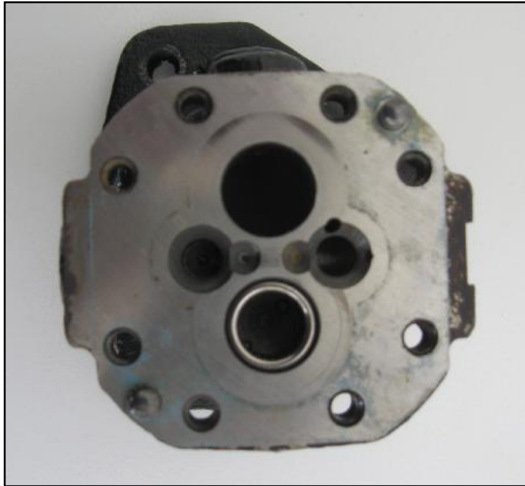
Figura. 1.6 Cuerpo de la bomba de combustible.
