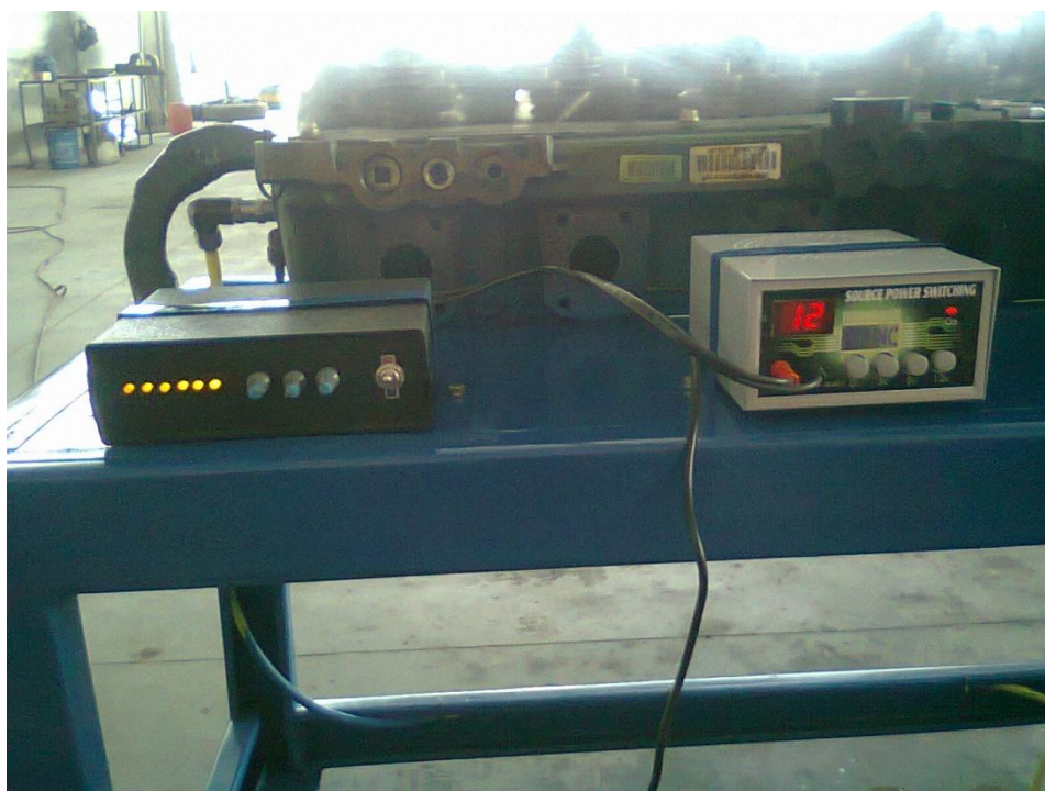
Montaje del Circuito de Inyectores sobre la Estructura Metálica
