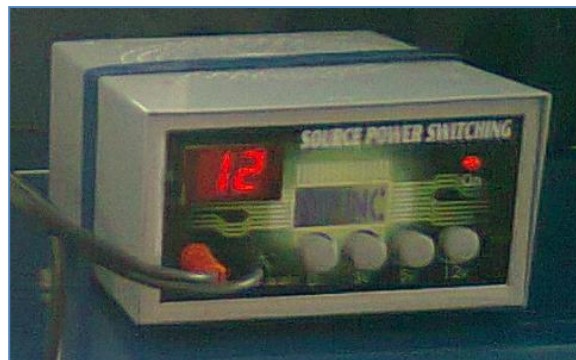
Figura. 2.34 Fuente de Voltaje del Banco de Inyección.
