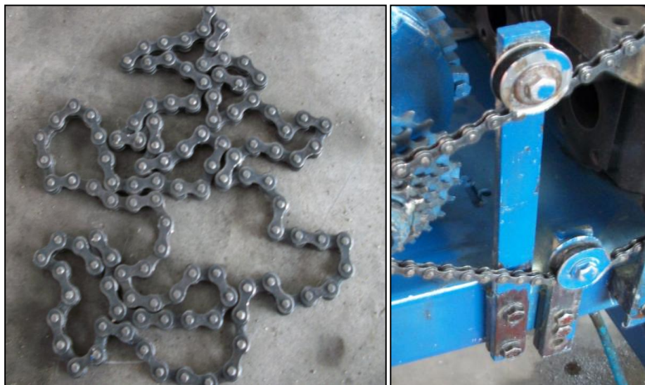
Figura. 2.15 Cadena y Templadores de Cadena.
