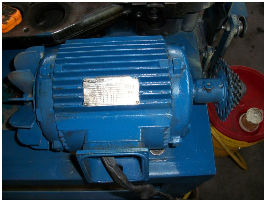
Montaje del Motor Eléctrico en la Estructura Metálica
