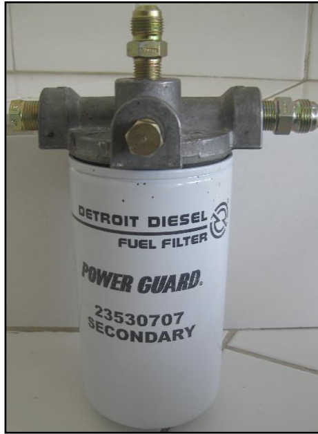
Figura. 1.14 Base y Filtro de Combustible Secundario.
