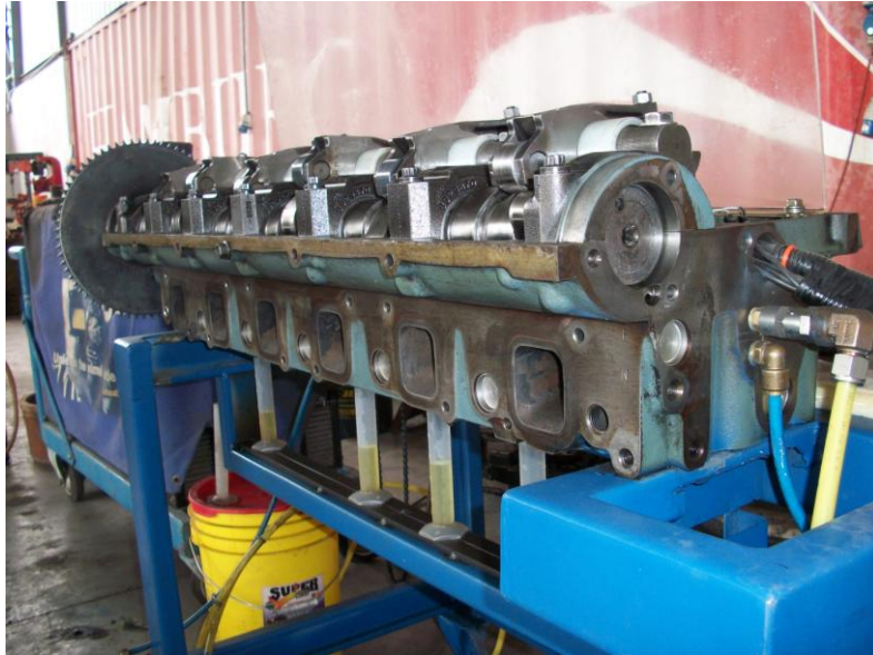
Montaje del Cabezote sobre la Estructura Metálica
