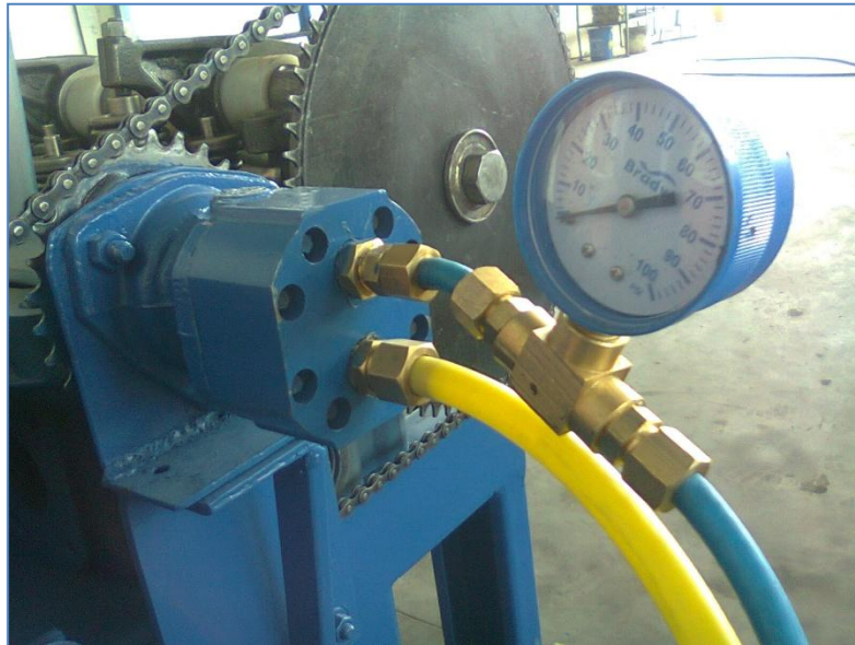
Figura. 2.19 Instalación de un Manómetro de Presión de Fluido a la Salida de la Bomba de Combustible.
