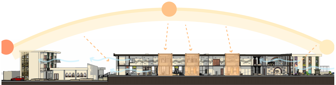
Figura 166: Iluminación y ventilación natural
