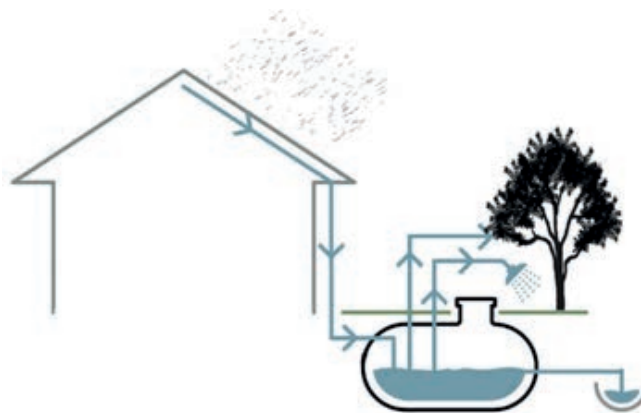
Imagen 23. Recogida de aguas pluviales
