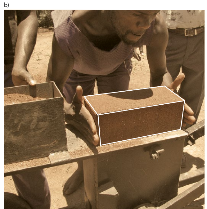
Imagen 26. a) Construcción de equipamiento. b) Elaboración de adobes Nota: Adaptado por la autora. Fuente: Archdaily.
