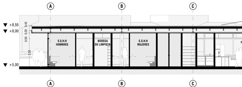
SECCIÓN LONGITUDINAL PABELLÓN CULTURAL COMERCIAL. N = +5,00 1:100
