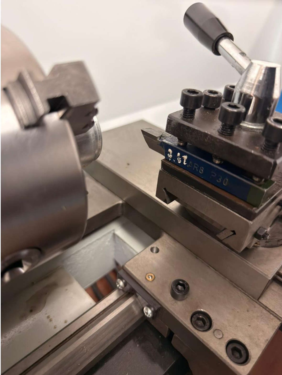
Anexo 14: Aseguramiento de la cuchilla en el Torno
