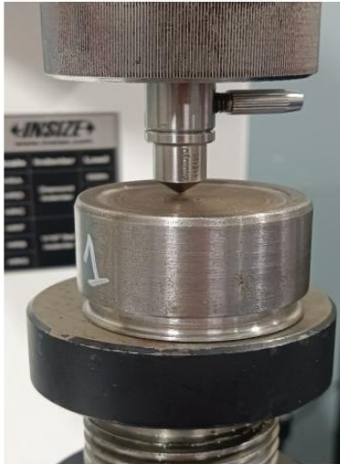
Fotografía 1. Montaje de la muestra M1 para ensayo de dureza.
