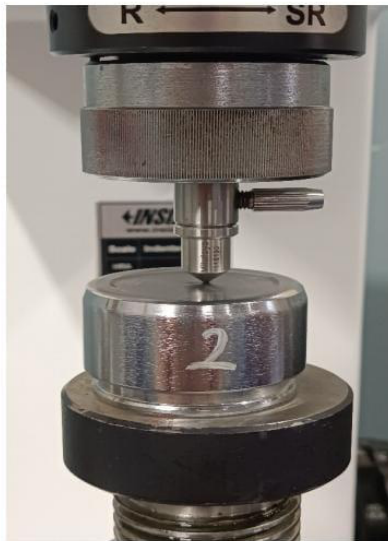
Fotografía 2. Montaje de la muestra M2 para ensayo de dureza.
