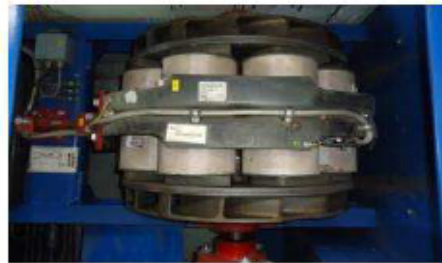
Figura 8-2: Freno de corrientes parásitas Fuente: (Pinto, 2017)
