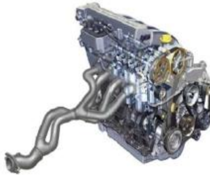
Figura 9-2: Múltiple de escape junto al motor Fuente: (ARGUMEDO, 2012)
