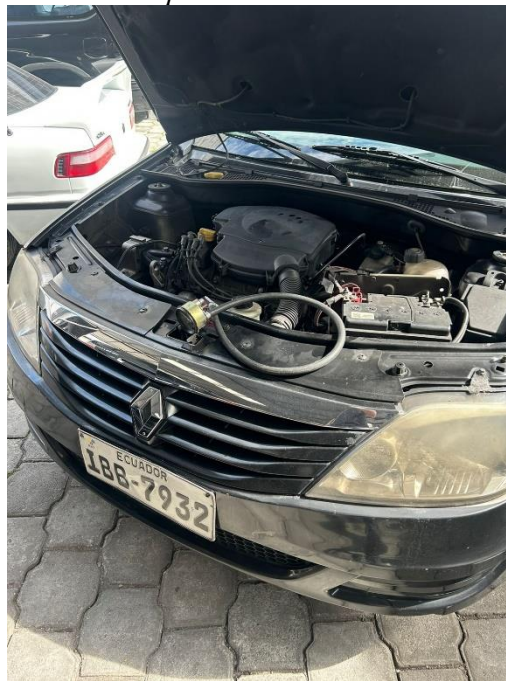
Figura 17. Instalación del vacuómetro en el vehículo para medición
