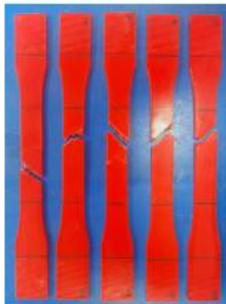
Figura 2. Condiciones finales de las probetas del grupo "Prusa" después de los ensayos de resistencia a tracción tomando como referencia la norma ASTM D638-22.
