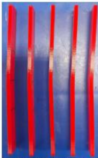
Figura 4. Condiciones finales de las probetas del grupo "Prusa" después de los ensayos de resistencia a flexión tomando como referencia la norma ASTM D790-17.
