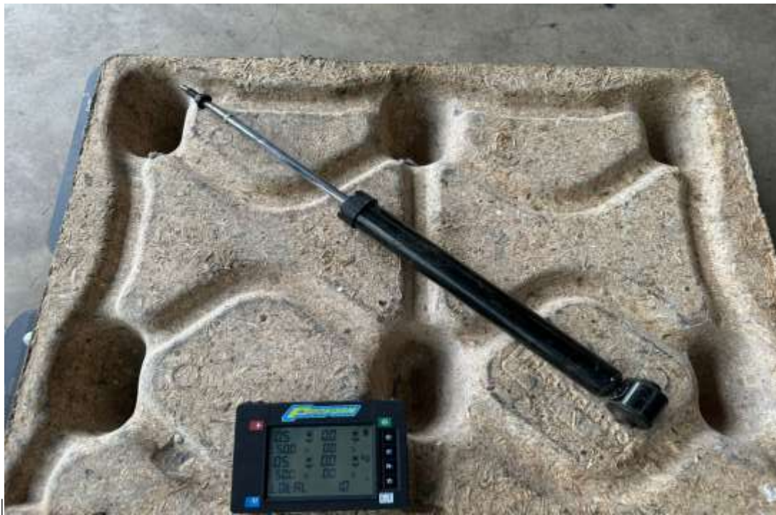
Anexo P. Amortiguador posterior original del Hyundai Grand i10
