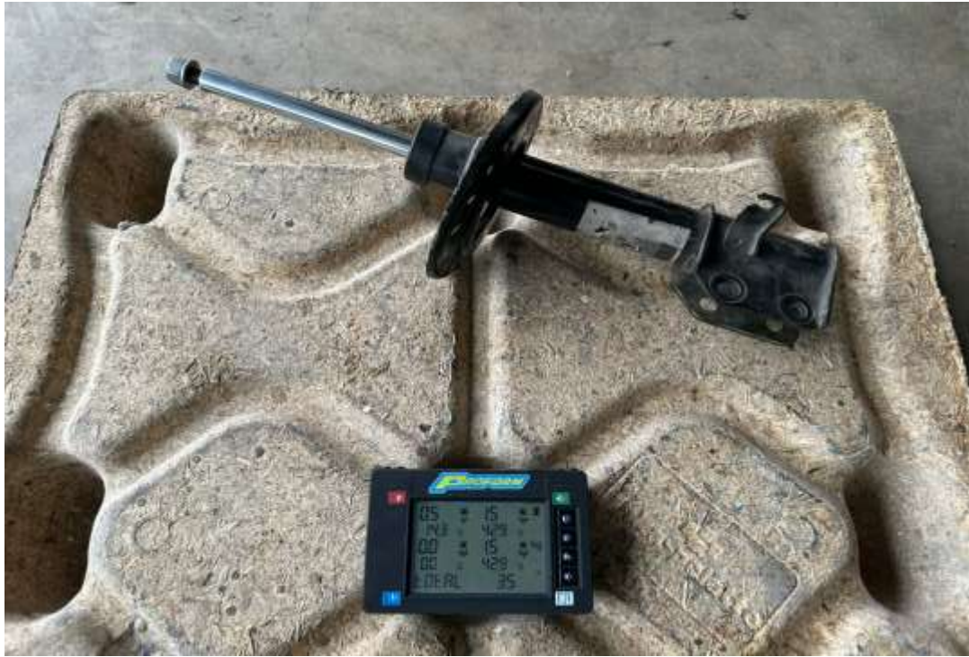
Anexo P. Amortiguador posterior original del Hyundai Grand i10
