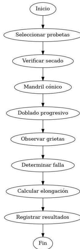
Figura 6. Diagrama de Flujo prueba de flexibilidad
