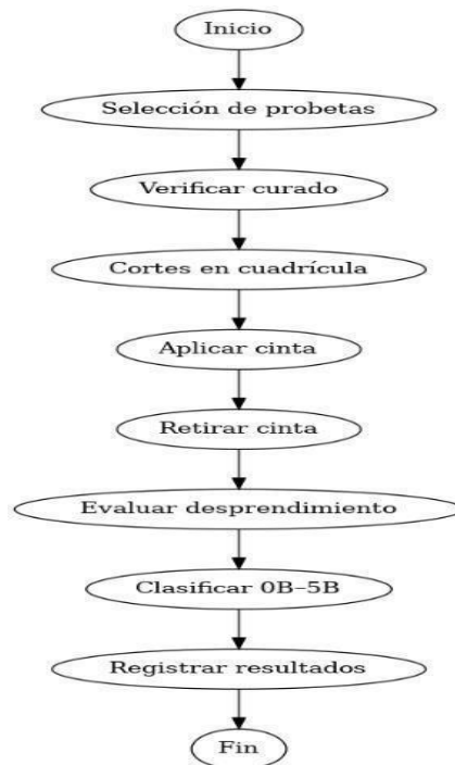
Figura 5. Diagrama de Flujo Prueba de adherencia
