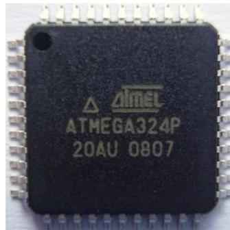
**Figura 3.31 Microcontrolador ATMEGA324P**
