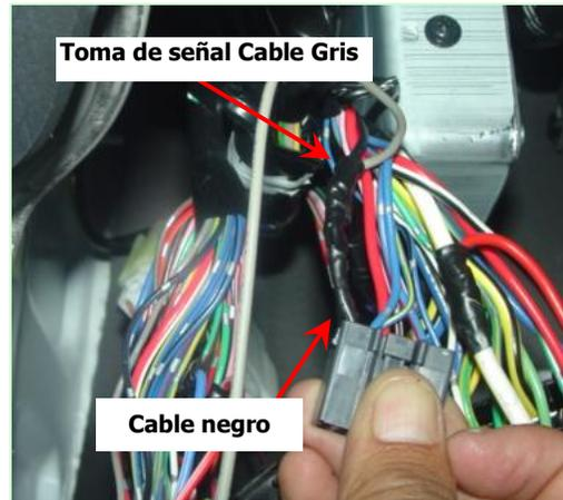
**Figura 6.75 Toma de señal GND**
