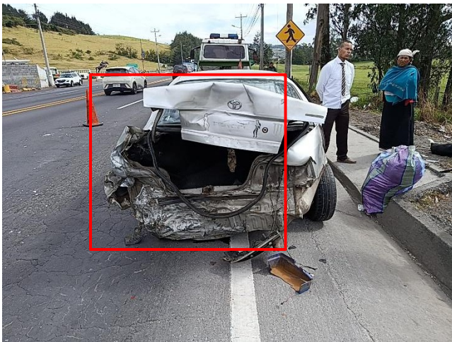
Fotografía Nro. 8.- De semi conjunto, donde se aprecia los daños materiales que sufre móvil (1), producto del impacto "A", de móvil (2).
