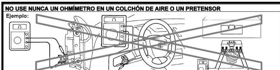
**Figura 4. 3.** Precauciones del airbag.
