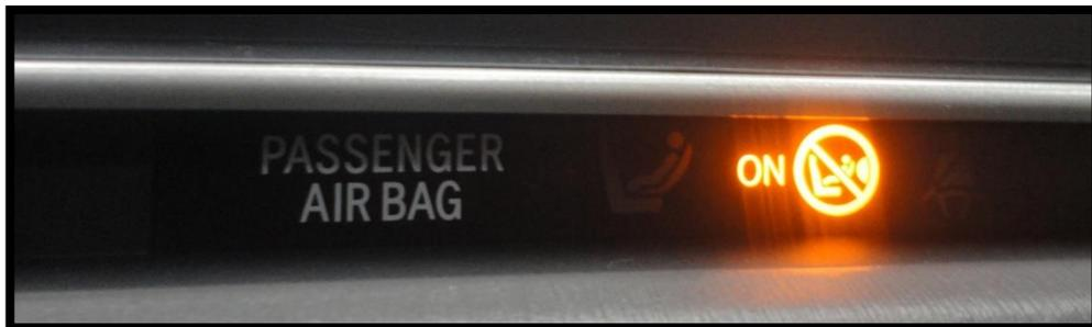
**Figura 5. 5.** Testigo luminoso del airbag del pasajero.
