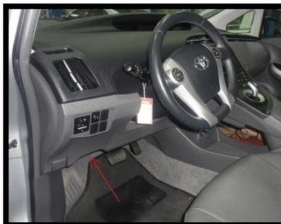
**Figura 3.16.**Ubicación del Conector OBDII del Prius.
