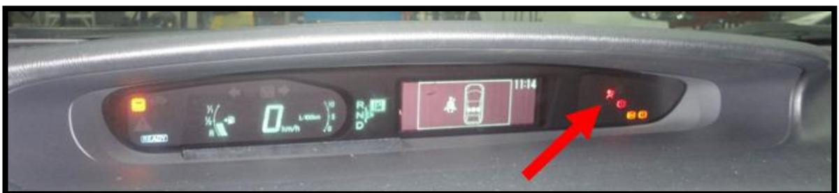
**Figura 5. 7.** Testigo luminoso del sistema SRS.
