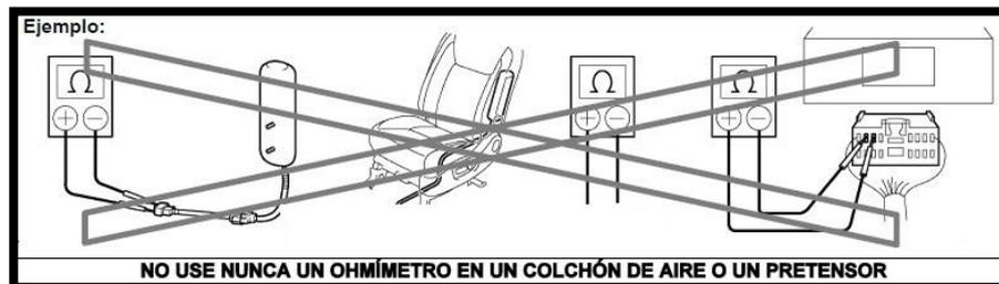
**Figura 4. 8.** Precauciones del airbag del asiento.
