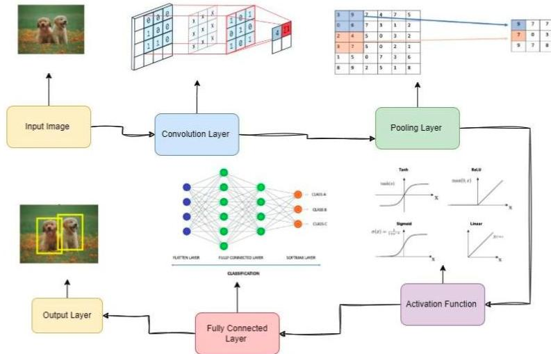
**Nota.** La arquitectura muestra el flujo de procesamiento desde la imagen de entrada, pasando por la capa convolucional, la capa de pooling, hasta la capa totalmente conectada y la función de activación. Adaptada de Taye (2023).
