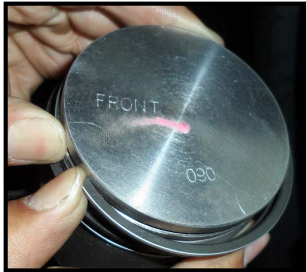
Figura 2. 6 Aros montados en pistones de motor Mini Austin Fuente.- Pozo, Iván & Cabezas, Andrés. 2013
