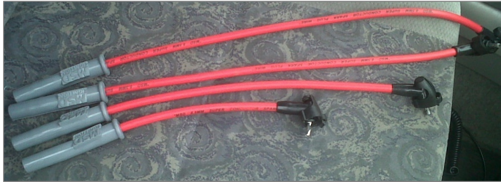
Figura 3. 37 Cables MSD de alto voltaje para motor de mini Austin Fuente.- Pozo, Iván & Cabezas, Andrés. 2013
