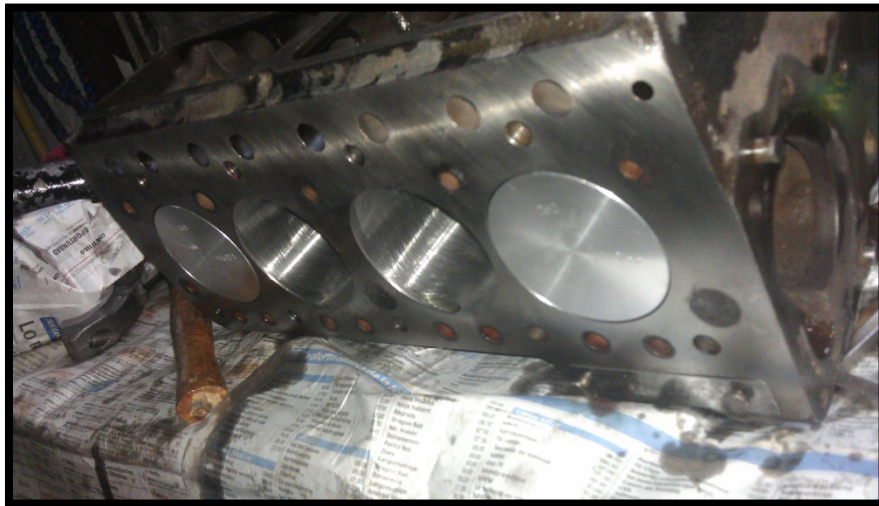
Figura 3. 3 Plano superior del bloque de cilindros y sus pistones planos
