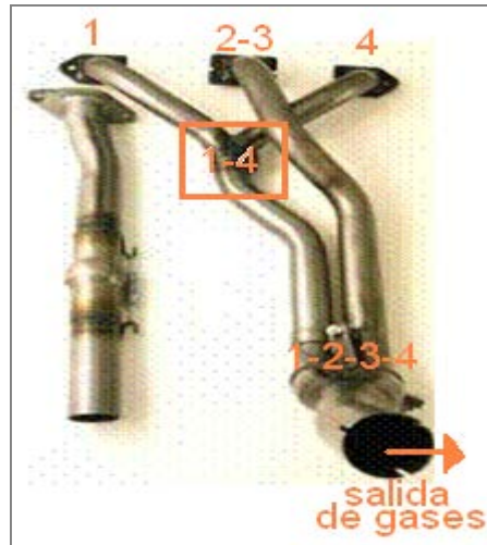
Figura 3. 29. Header creado para motor modificado
