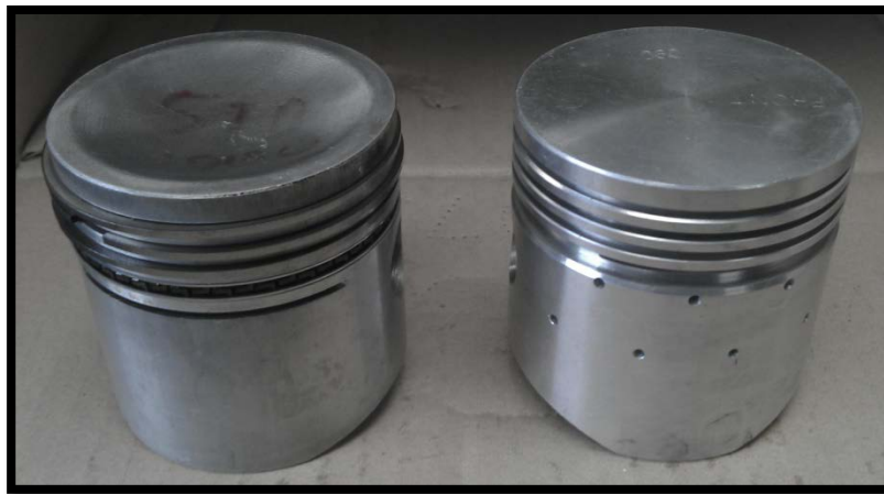
Figura 3. 20 Lubricación de la falda del pistón de motor Mini Austin
