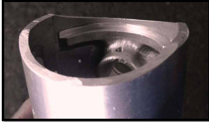
Figura 3. 21 Falda desbastada del pistón Fuente.- Pozo, Iván & Cabezas, Andrés. 2013
