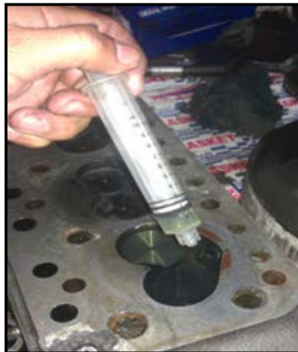
Figura 2. 7 Medición del volumen de la cámara de combustión Fuente.- Pozo, Iván & Cabezas, Andrés. 2013
