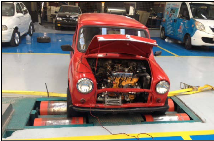
Figura 3. 39 Pruebas en el dinamómetro para mini Austin Fuente.- Pozo, Iván & Cabezas, Andrés. 2014
