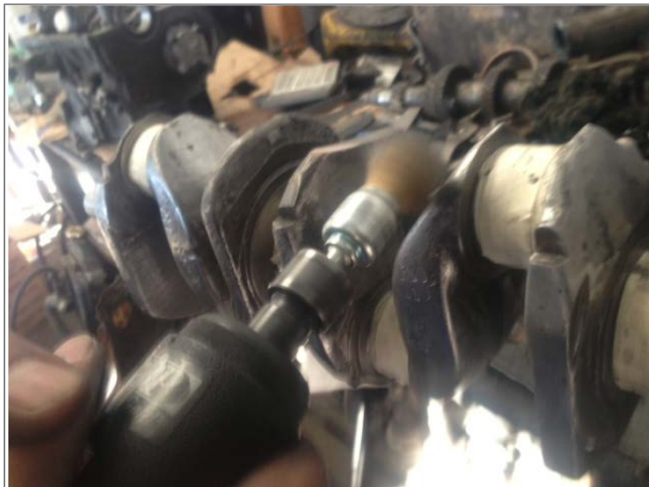
Figura 3. 24 Mecanizado del cigüeñal de Mini Austin
