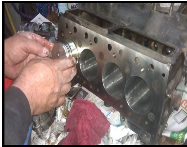
Figura 3. 4 Bloque cepillado y cilindros rectificados Fuente.- Pozo, Iván & Cabezas, Andrés. 2013
