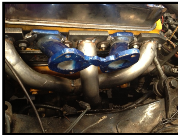
Figura 3. 31 Header para el motor repotenciado de Mini Austin
