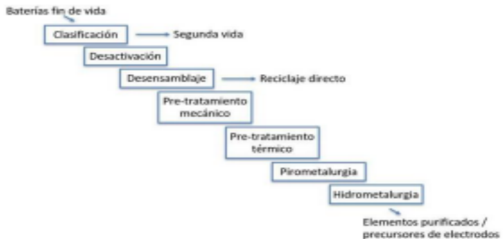
Figura 10: Ciclo completo de una batería de fin de vida con los distintos tratamientos y procesos a los que se puede ver sometido para su reciclado [17].
