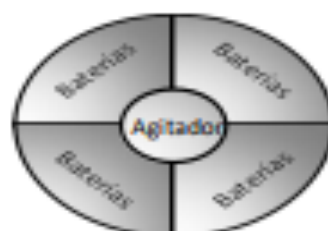
Figura 11: Distribución de la carga de sólidos en el interior del tanque [2].
