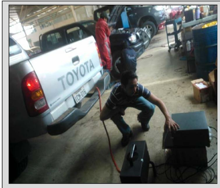
Fuente: Pruebas de Opacidad a vehículos con motor diesel
