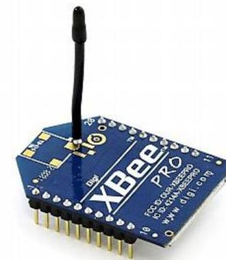
**Figura 4.22** Módulo Xbee
