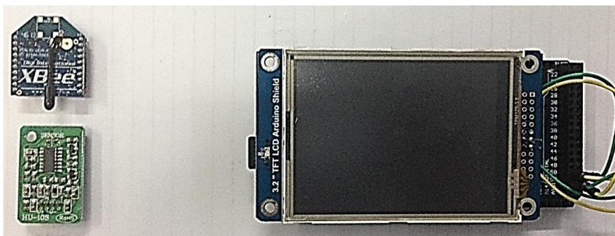
**Figura 4.27** Placa receptora “madre”, conectada al sensor de temperatura de forma por medio del módulo inalámbrico Xbee
