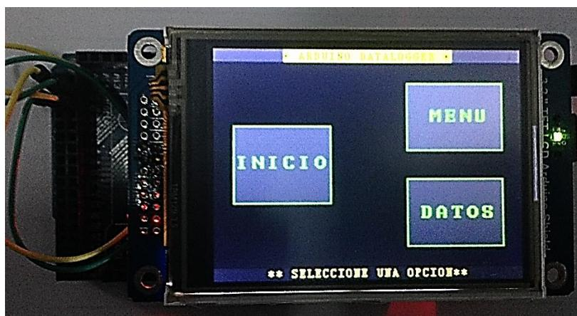
**Figura 4.28** Panel de Inicio - Módulo de Adquisición de Datos
