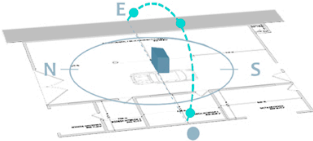
Ilustración 8: Elaborado por el autor, 2025, asoleamiento de plano de edificación.
