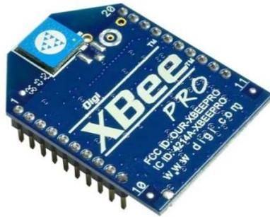
**Figura 2.16** XBEE Pro
