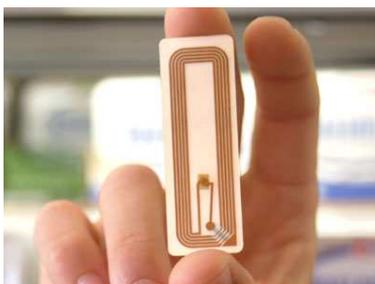
**Figura 2.11** Módulo RFID
