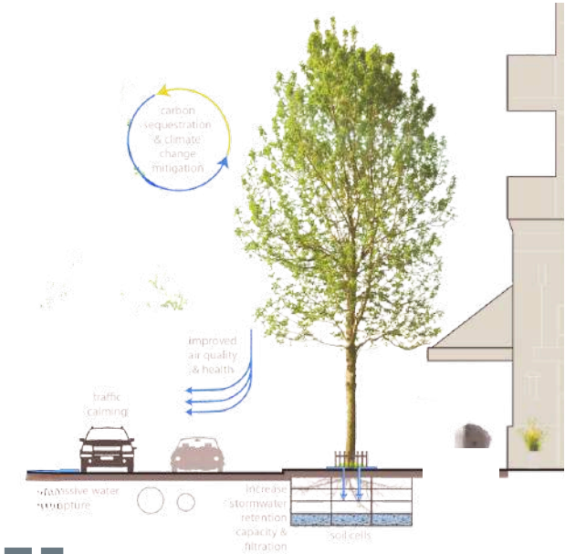
Recolección Aguas LLuvias
