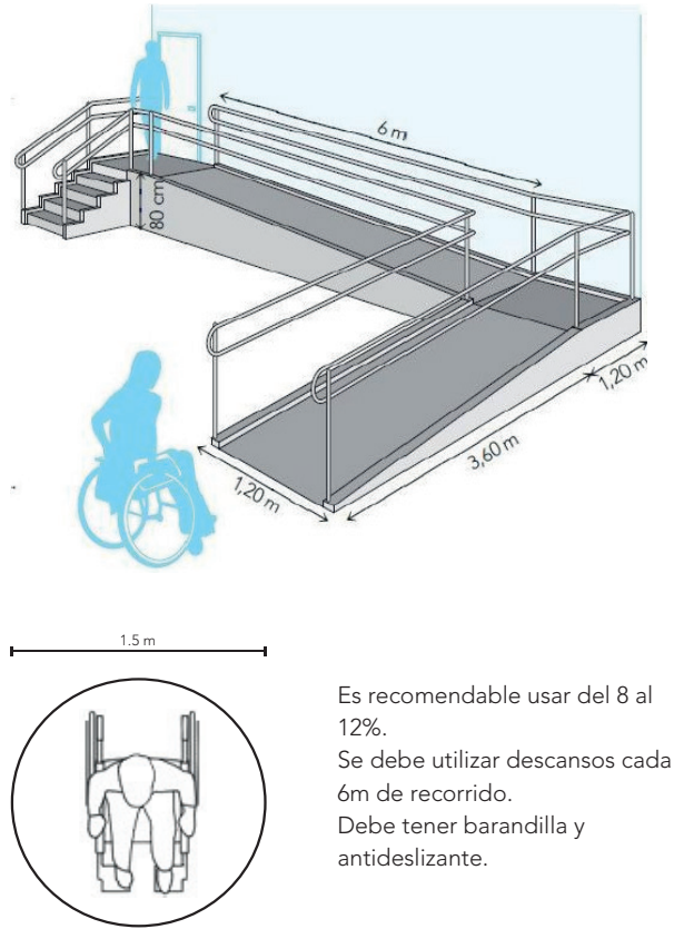
Figura 18. Rampa de accesibilidad
