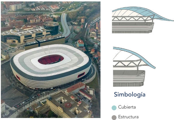
Figura 40. Esquemas de cubierta Estadio San Mamés
