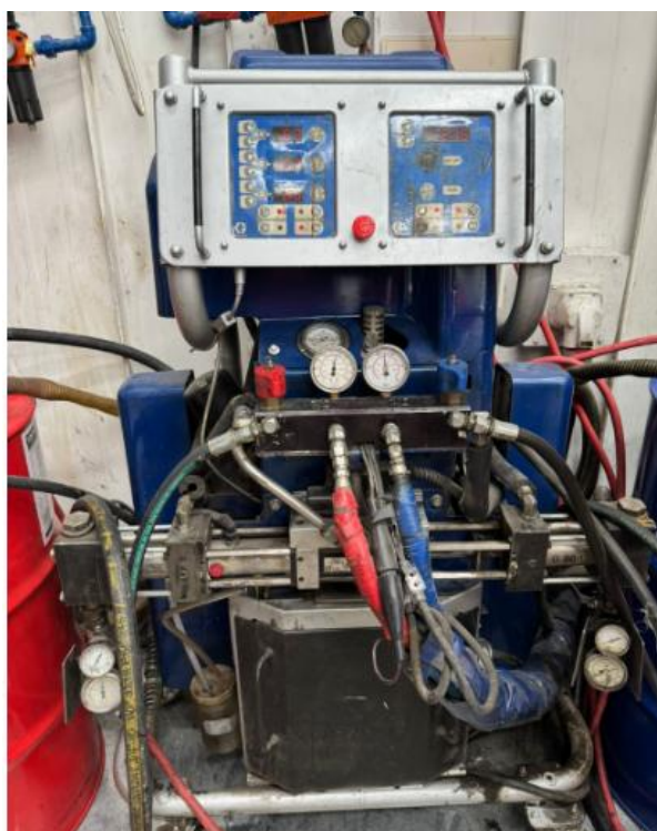
Figura 2. Equipo de aplicación de recubrimiento
