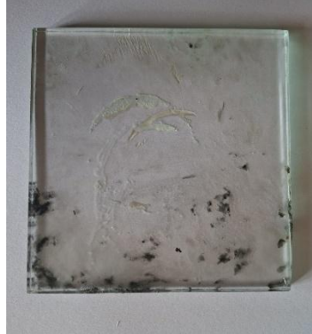
Figura 7. Probeta para prueba de secado
