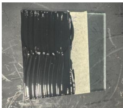
Figura 9. Probeta para tiempo de secado
