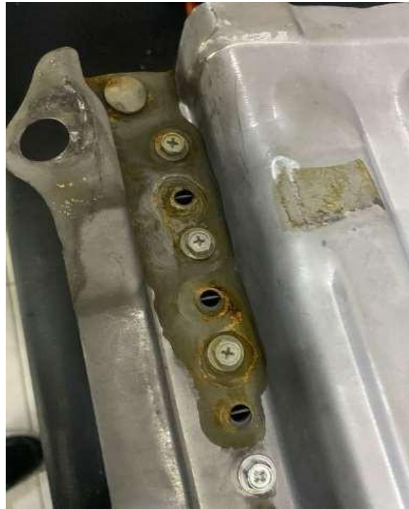
Figura 10: Oxidaciones en componentes
