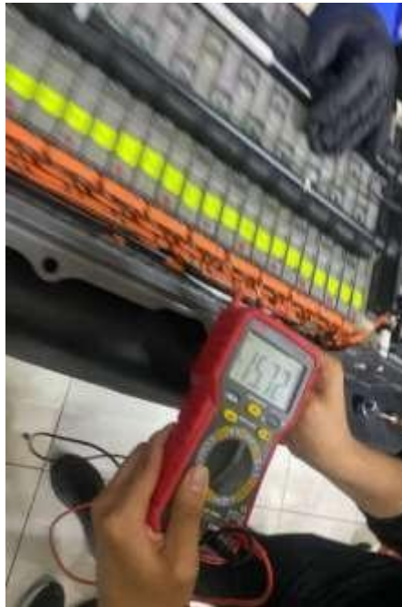
Figura 14: Toma de mediciones con multímetro
