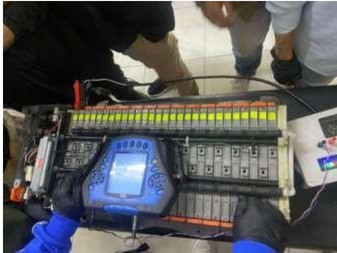
Figura 12: Pruebas con el OBD2
