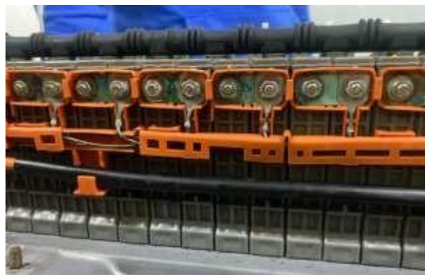
Figura 9: visualización de conectores
