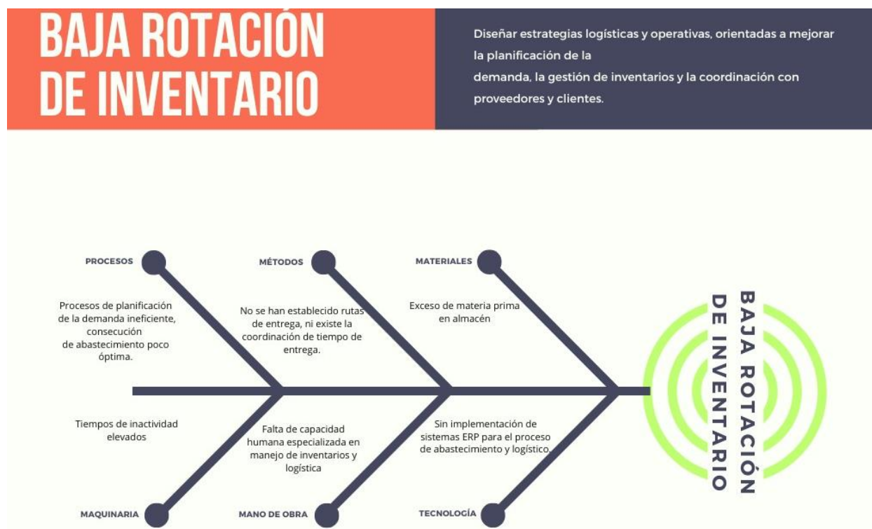
Figura 3 Diagrama de Ishikawa de la identificación de la baja rotación de inventario de Curtiduría Tungurahua, 2025
