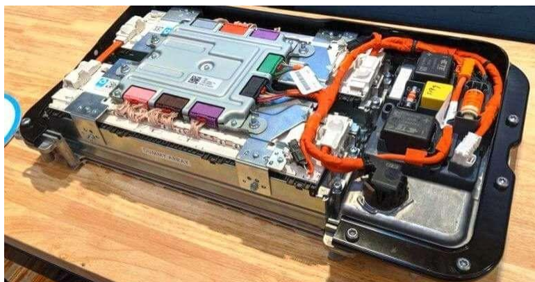
Análisis Interno de una Batería de un VE
