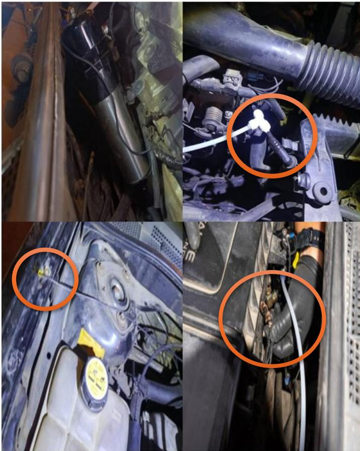
Instalar el sistema de electrólisis seca HHO en el compartimento del motor de un vehículo Mazda implica una serie de pasos, que se muestran en la figura compuesta 6. Este sistema se instaló para averiguar cuánto afecta la cantidad de contaminantes que se liberan al aire cuando cambian las condiciones.
