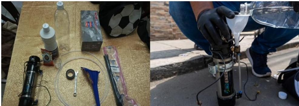
Las partes necesarias para instalar el sistema se muestran a la izquierda. Estos son el electrolito (que es una mezcla de agua destilada con bicarbonato), las mangueras, las abrazaderas, el embudo, la fuente de alimentación y el generador de HHO. Esta imagen muestra el momento en que el embudo vierte la solución electrolítica en el sistema. Esto prepara el generador para ser encendido, como se ve en el lado derecho de la imagen.
