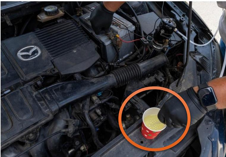
La prueba de burbujeo de hidrógeno en la figura 5 es una parte importante para asegurarse de que el sistema de electrólisis seca HHO esté funcionando bien. El generador de HHO está conectado a la batería del Mazda. Este enlace permite que la solución electrolítica pase por el proceso de electrólisis. Durante la prueba de funcionamiento, se acerca un recipiente con agua jabonosa a la salida del generador de gas HHO para verificar visualmente la producción de gas.
