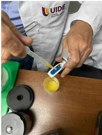
Figura 32. Muestra de la bebida en el brixómetro Autor,2023.
