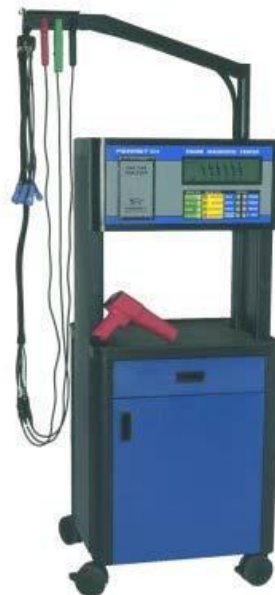
Figura 4.2: Analizador de motores
