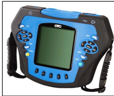
Figura 4. 14. Osciloscopio automotriz OTC 3840F Fuente: Instrumentos electrónicos básicos, Pallás, 2006 p. (116) Editado por: Ronald Ortiz
