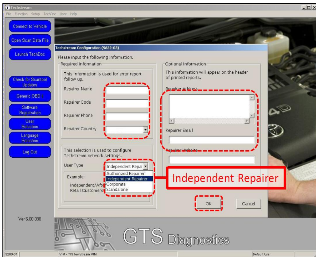
Figura 2. 13. Paso N°9 para la instalación del Tech Stream en una PC.
