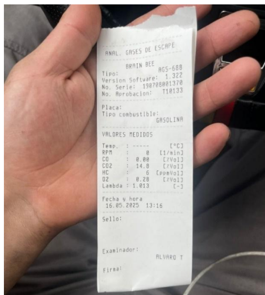
Figura 4.26 Resultado del analizador de gases, con aditivo Nota. Elaboración propia.
