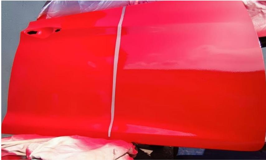
Se debe destacar que luego de pintar la chapa metálica automotriz se deja en reposo la elemento pintado al menos por 24 horas, y despues se procede a dar el brillo.
