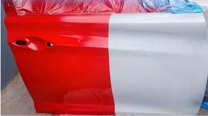
Luego se procedió a pintar con el sistema tradicional en el lado derecho como se muestra en la figura 22, luego se deja el proceso de secado de la misma forma por 30 minutos para alcanzar un secado apropiado, se destaca que en toda la prueba se utilizó la pistola eléctrica al máximo de carga, y las pistola de aire se trabajó a 30 PSI.
