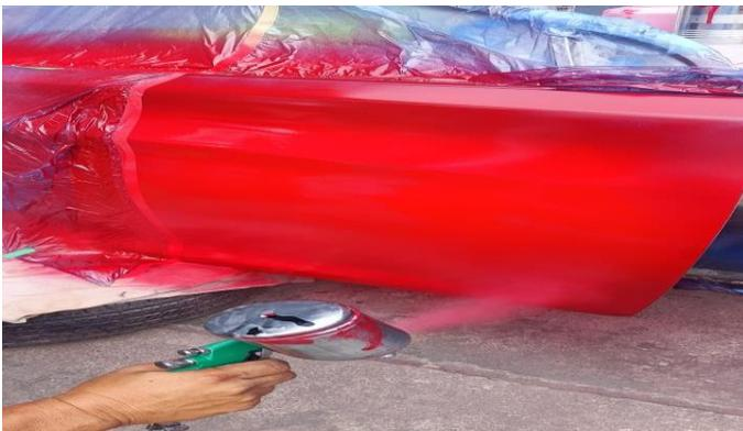
Seguido se le aplicará una segunda capa de pintura base agua con el equipo de pintura SnapFresh Power y el proceso tradicional de presión de aire, luego de ello se analiza si hay algún tipo de imperfección y de ser necesario se debe aplicar una tercera mano de pintura, y se realiza una nueva revisión de la chapa metálica para verificar algún tipo de anomalías en el
