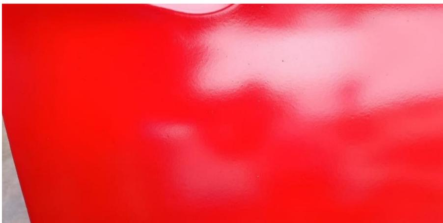
Una vez que se aplicó la tercera capa de pintura base agua con el equipo SnapFresh Power se puede resaltar que ya no se aprecia la diferencia con la aplicación de la pintura con el método tradicional lo cual se aprecia en la figura 25.
