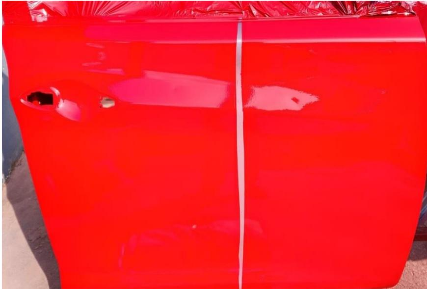
Se puede apreciar una ligera diferencia en el aspecto del acabado, ver figura 24, lo cual es manejable con una nueva capa de pintura y se pide solucionar el problema de la apariencia en la aplicación de la pintura con el equipo SnapFresh Power.
