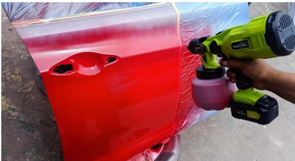
Después se deja actuar el proceso de secado por 30 minutos para proseguir con la segunda capa de aplicación de pintura, la aplicación de la primera mano se refleja en la figura 21, se destaca que solo se muestra pintado el lado izquierdo de la chapa automotriz, aqui se
