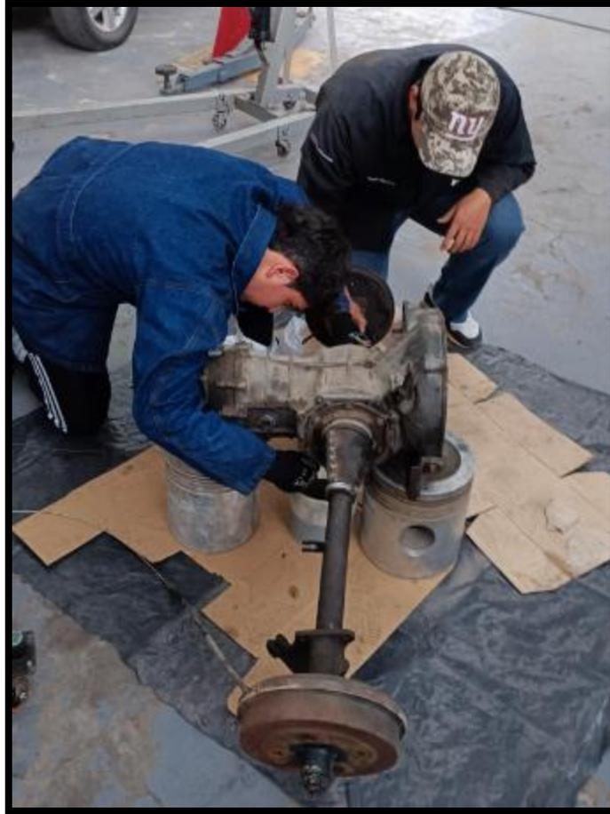
**Figura 4.8.1.9:** Separación de ejes (2)
