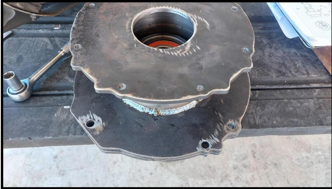
**Figura 7.10:** Parte Superior Placa Adaptadora
