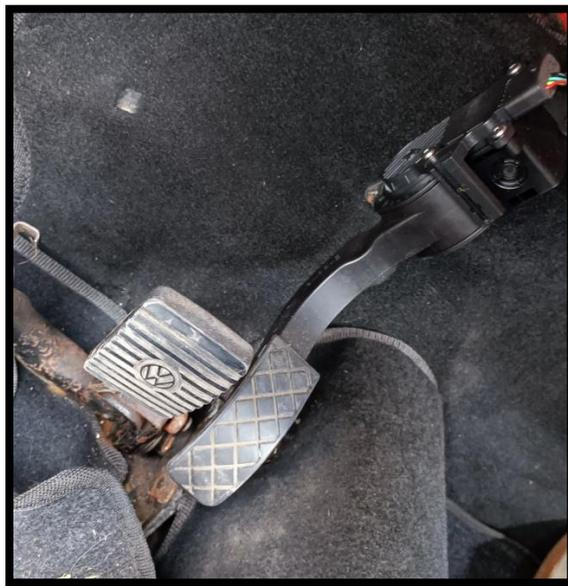
**Figura 4.6.4.1:** Acelerador electrónico
