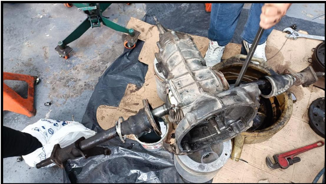
**Figura 7.4:** Desacople de ejes de a la transmisión
