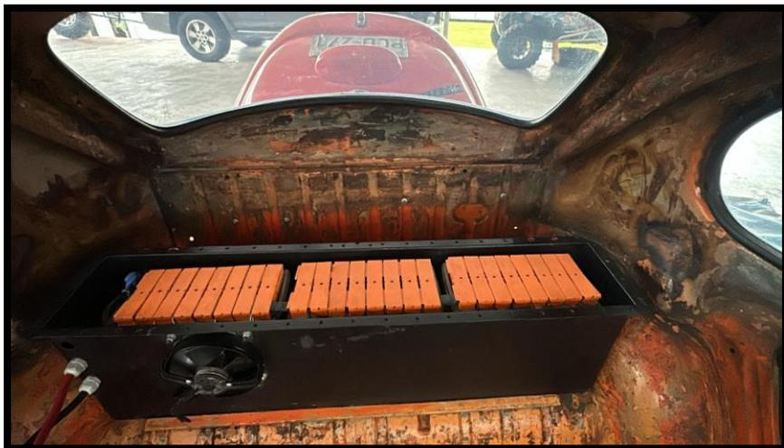
**Figura 4.9.3:** Instalación de Baterías de Litio LiFePO4
