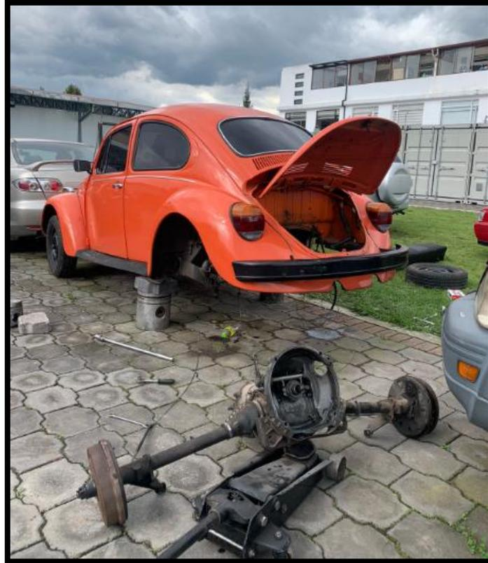
**Figura 4.8.1.6:** Desmontaje de transmisión (1)
