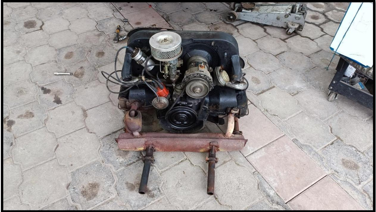
**Figura 7.8:** Motor de Volkswagen Escarabajo 1600 desmontado
