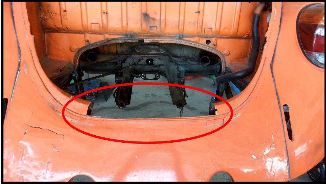
**Figura 7.12:** Corte en la carrocería para la adaptación del motor
