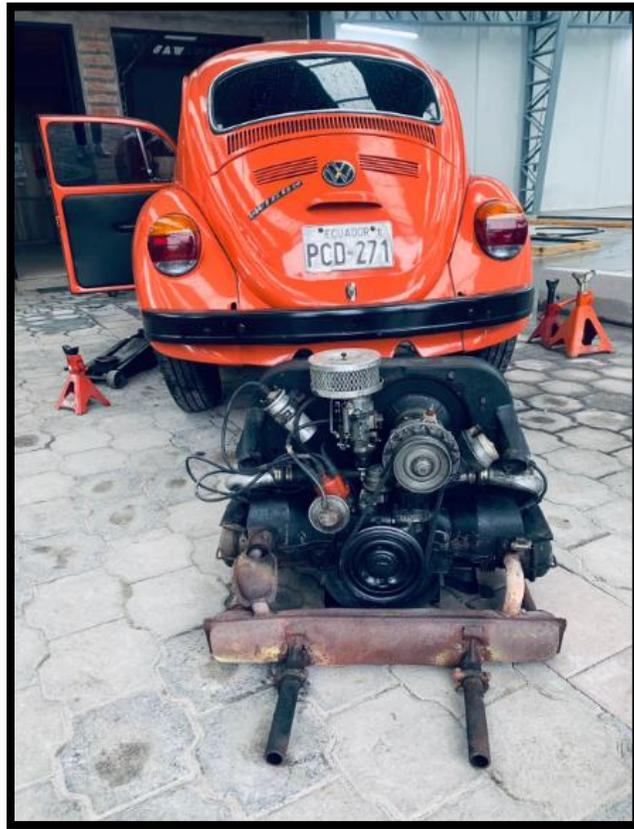
**Figura 4.8.1.4:** Desacople de motor
