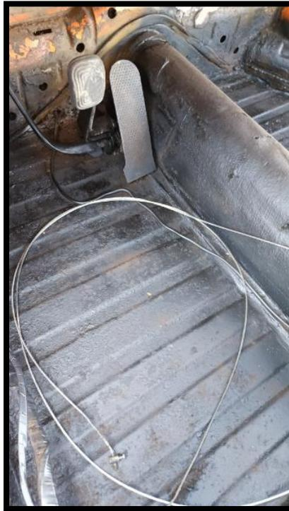
**Figura 4.8.1.11:** Cable y Pedal del Acelerador
