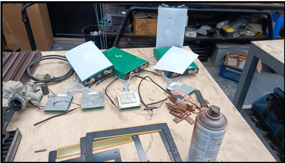
**Figura 7.2:** Armado de Paquete de Baterías
