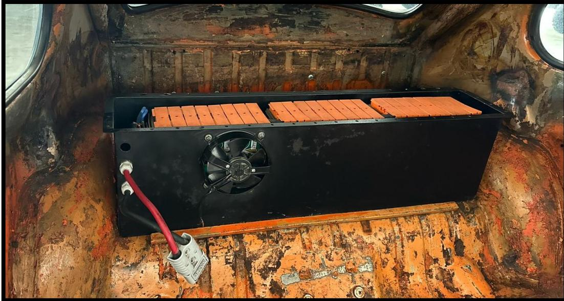
**Figura 4.6.13.1:** Carcasa para las baterías
