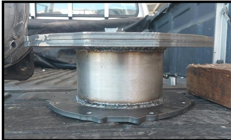
**Figura 4.7.1.1:** Placa Adaptadora
