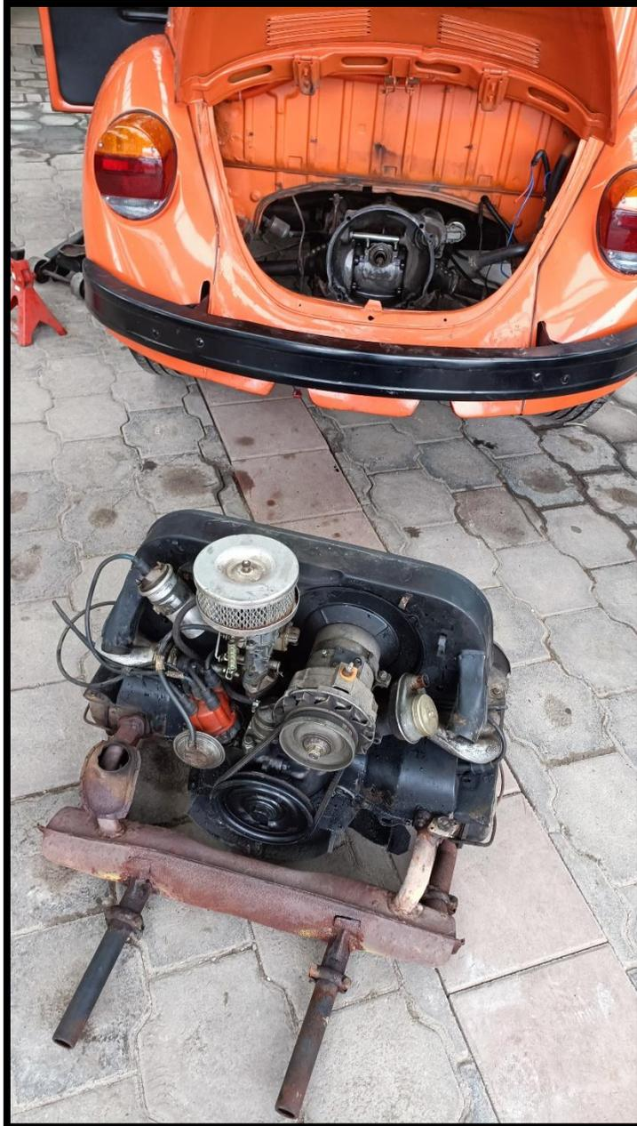
**Figura 7.7:** Desacople de; motor de la transmisión
