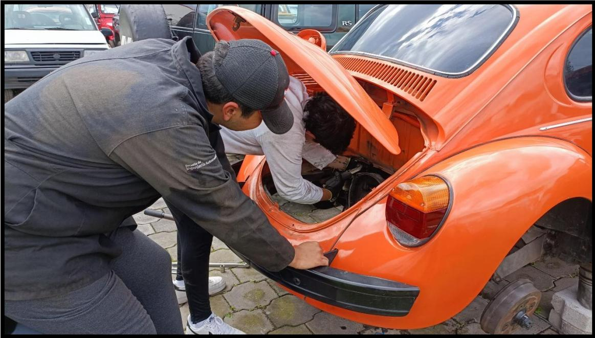
**Figura 7.6:** Desacople de a la transmisión de la carrocería (4)
