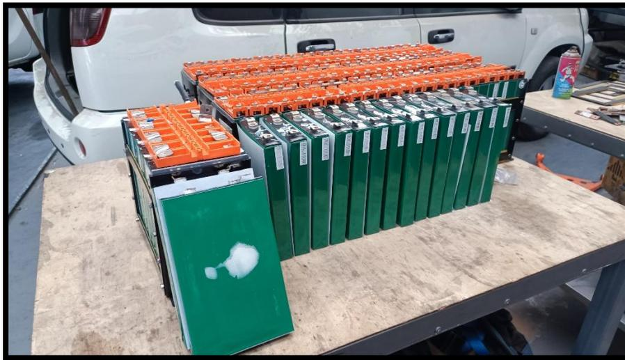
**Figura 4.6.8.1:** Celdas de Baterías de LiFePo4
