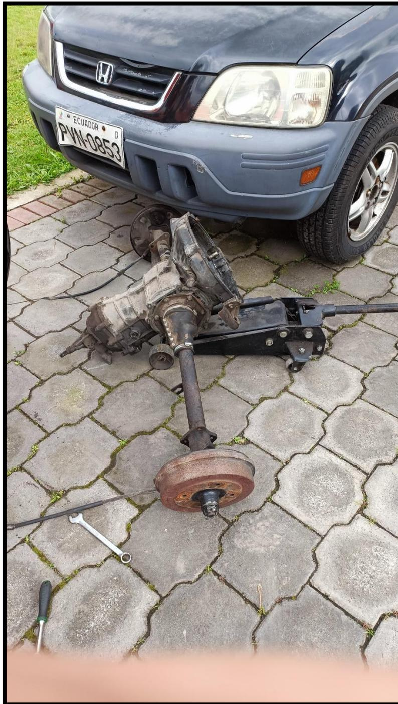
**Figura 7.5:** Desacople de a la transmisión de la carrocería
