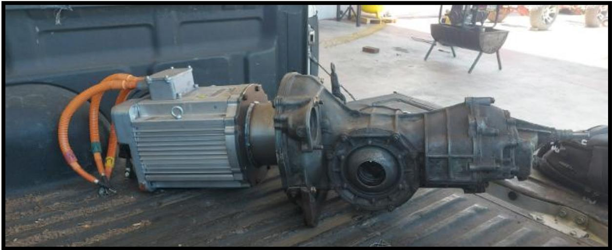
**Figura 4.9.1:** Unión Motor Eléctrico, Caja del vehículo
