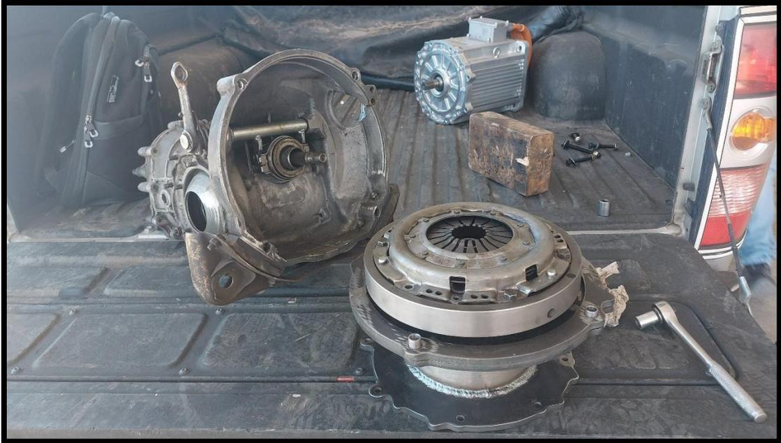
**Figura 7.18:** Instalación Embrague al acople Caja-Motor
