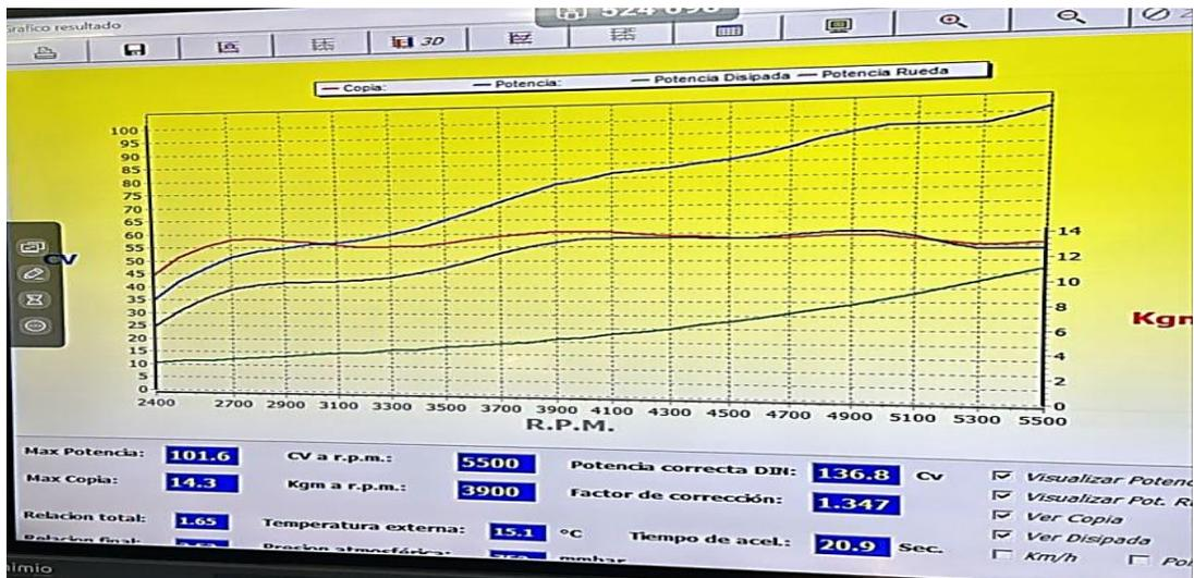
**Nota.** Los resultados obtenidos con el combustible super son el tiempo de aceleración de 20,9 segundos, revoluciones por minuto de 5500 RPM, con una potencia de 101.6 CV al igual que en torque de 14.3 Kgm y una velocidad máxima de 198 Km/h. Fuente (Autores, 2024).
