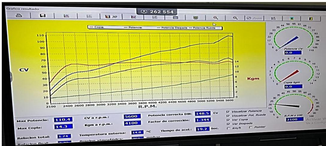
**Nota.** En el siguiente grafico se visualiza los resultados obtenidos con el combustible de plástico el tiempo de aceleración es de 19.2 segundos, revoluciones por minuto 5600 RPM, con una potencia de 110.4 CV al igual que en torque 14.3 Kgm y una velocidad máxima de 201 Km/h. Fuente (Autores, 2024).
