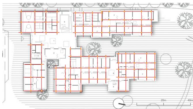
Ilustración 18. Retícula estructural del sist. constructivo
