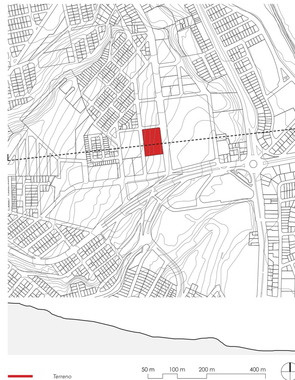
En el área analizada correspondiente a un radio de 500m, se evidencia una topografía irregular, con una pendiente que desciende desde el Oeste hacia el Este, siendo mucho mas evidente en la zona Noroeste.
