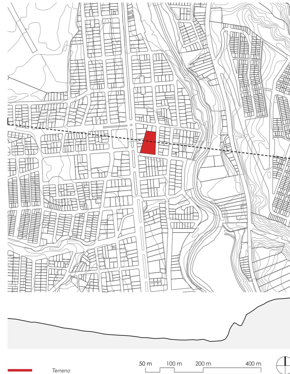
En el área analizada correspondiente a un radio de 500m, se evidencia una topografía medianamente uniforme en el epicentro de la zona y fracturada hacia el Este y el Oeste, siendo que hacia el lado Este se presenta mas disparidad.
