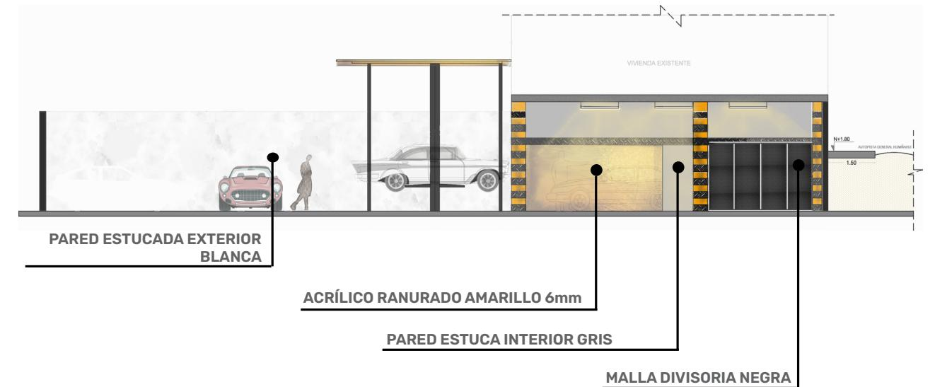
Ilustración 41: Gissela Manosalvas, elevación de revestimientos verticales
