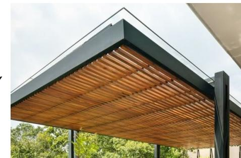
Los elementos de fijación al suelo y a la pared no van incluidos, deben ser elegidos en función del tipo de su suelo y de su pared. (Orificio Ø12 previsto en las platinas bajas y en las columnas murales), será necesario prever una estanqueidad entre la pared y la pérgola por medio de una bovedilla en chapa. -En falta de una losa de hormigón en 500x500x500mm + armadura de 25mmx3mm, silicona, caucho para relleno de juntas, herrajes para ensamble de estructura
