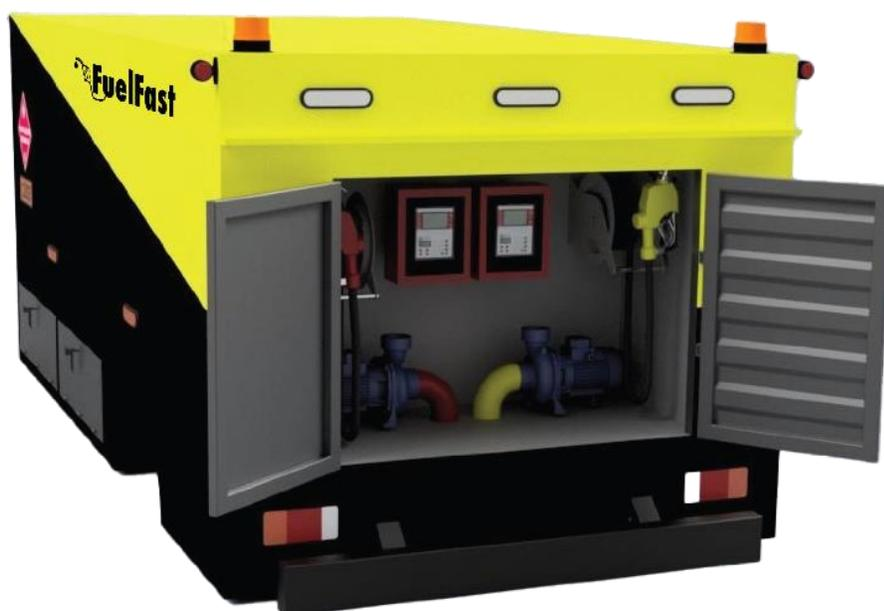
*Nota:* Vista trasera del camión cisterna de FuelFast donde se aprecian las bombas de combustible y elementos de seguridad. Elaboración propia.
