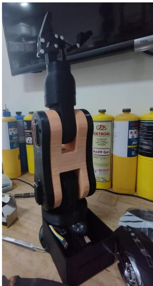
Se examinaron cuidadosamente las conexiones eléctricas para prevenir errores en el abastecimiento de energía, y se llevaron a cabo pruebas de comunicación entre el microcontrolador y los actuadores para asegurar la adecuada sincronización de todos los subsistemas. Este método sistemático permitió que todos los elementos operaran de forma sincronizada, satisfaciendo los requerimientos operativos del robot.
