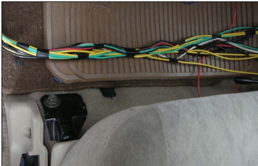
Figura 5.7. Cableado de los accesorios.
