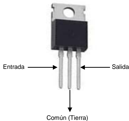
Figura 2.31. Configuración del patillaje del regulador 7805
