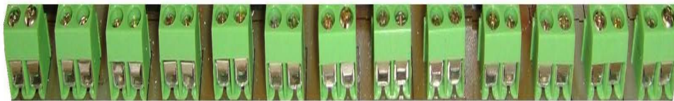
Figura 3.13. Vista frontal del grupo de borneras de salida de la placa PCB.
