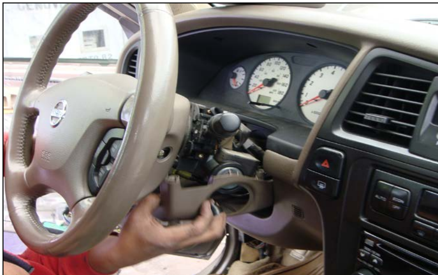
Figura 5.4. Desmontaje consola volante.
