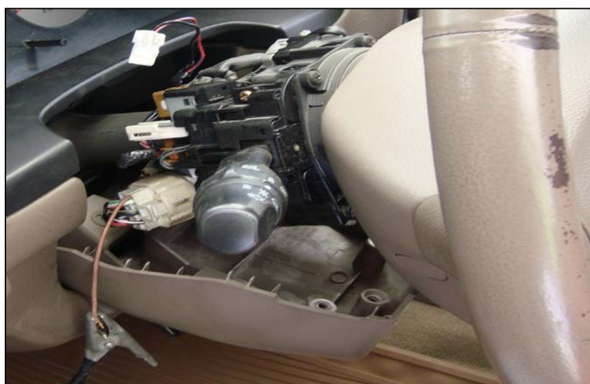
Figura 5.6. Ejemplo utilización lámpara de prueba para identificar cables Luces direccionales
