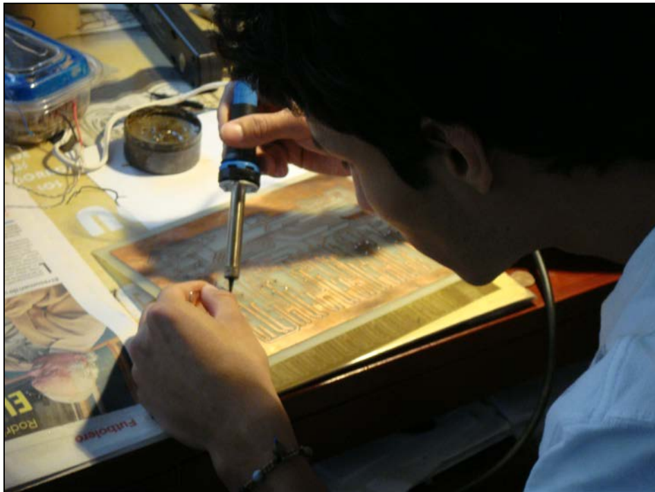
Figura 3.8. Soldadura de los materiales eléctricos en la placa PCB.
