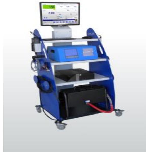
*Figura 3. Instrumento de medición Opacímetro, para la toma de muestras, Autores.*
