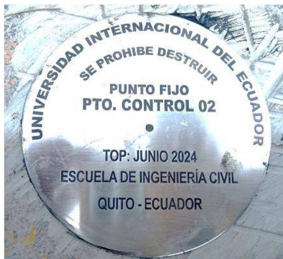
Imagen 13: Placa de acero inoxidable de identificación de cada hito de la red de control geodésica
