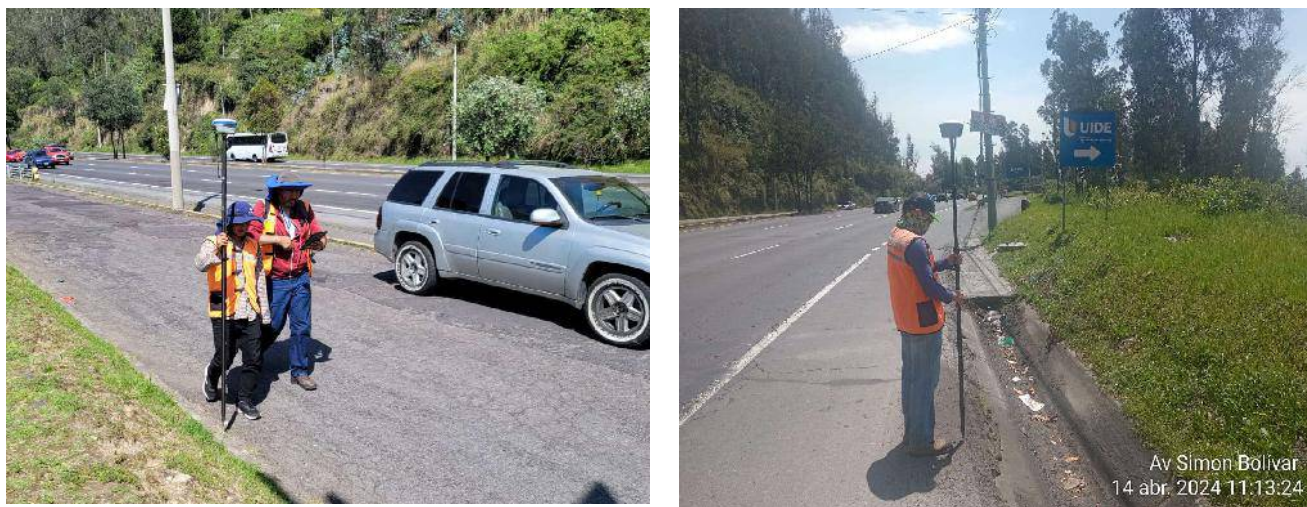
Imagen 21: Levantamiento topográfico mediante RTK.
