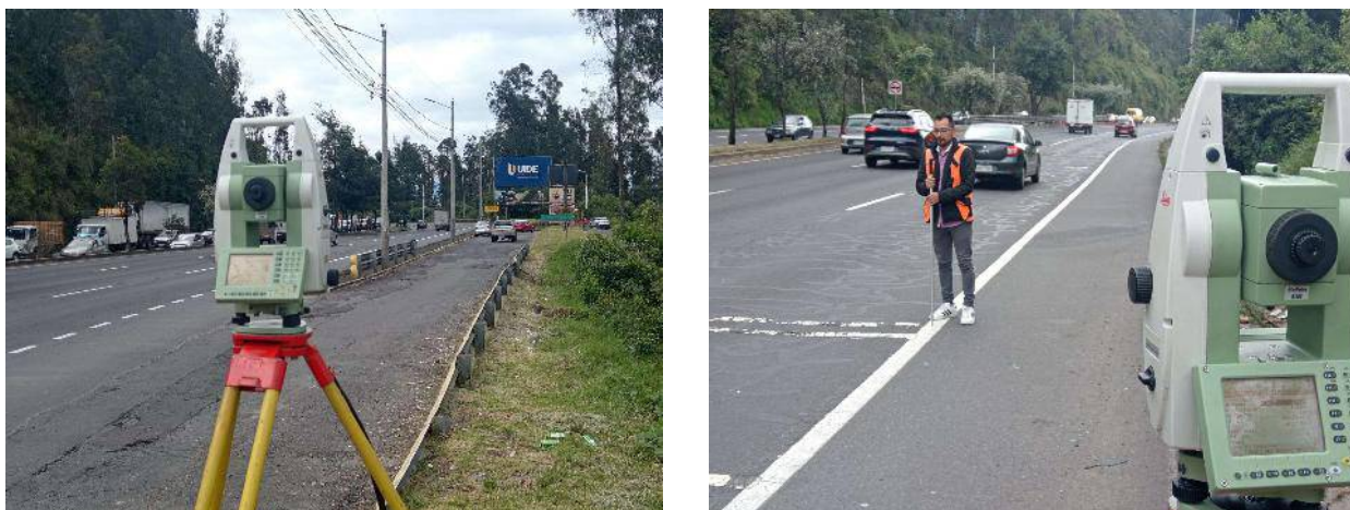
Imagen 20 Levantamiento topográfico tradicional con estación total.
